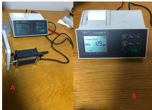
Şekil 4.2.2.1. A: Deney numunesi Ra ölçümü, B: Yüzey pürüzlülüğü ölçüm cihaz
