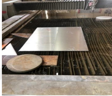
Şekil 2.1.1. Su Jeti Kesim Tablasına Malzeme Yükleme
