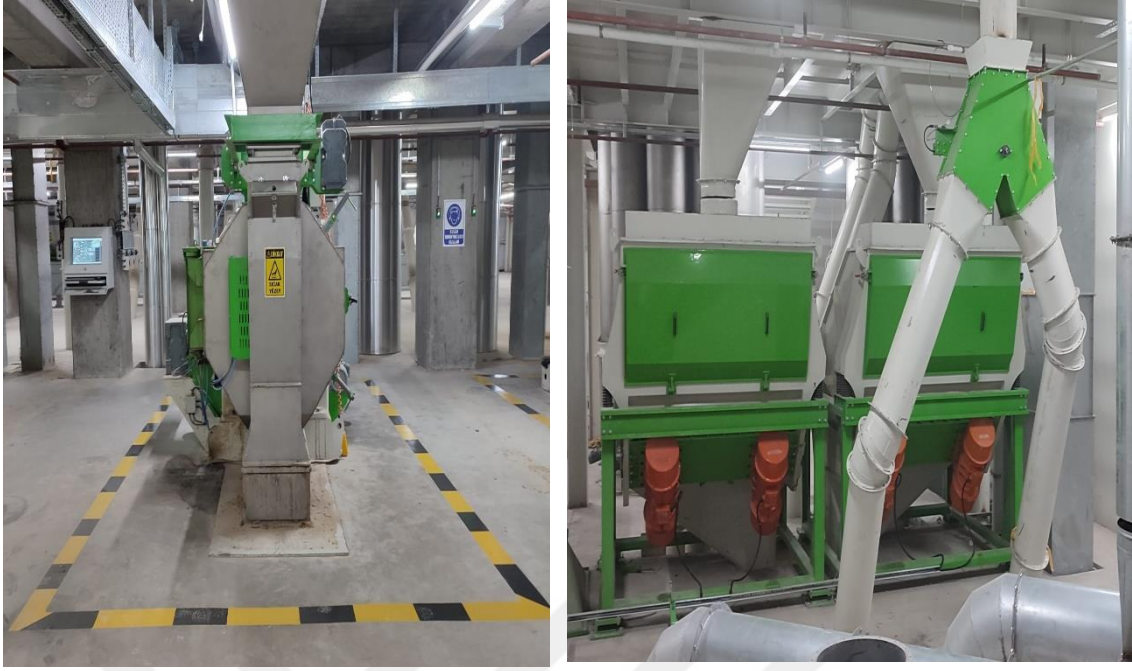
Şekil 2.15: Yem Üretim Prosesinde Gürültü Kaynakları (pres ve elek)
