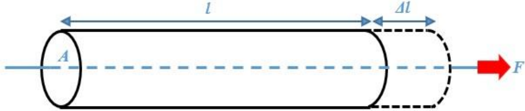
Şekil 3.4 : Bir cismin Young modülünün şematik görünümü, burada l başlangıç uzunluğunu, \Delta l ise kesit alanı ( A ) üzerine uygulanan kuvvet ( F ) tarafından meydana gelen uzunluk değişikliğini ifade eder [63].
