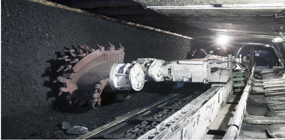
Şekil 2.24 Zincirli konveyör çalışma anı (AZO Mining, 2019)
