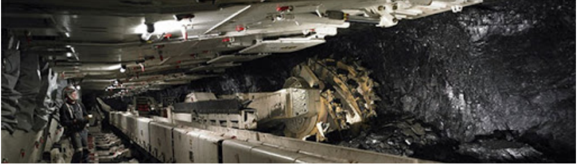
Şekil 2.20 L Tip çift tamburlu kesici yükleyici çalışma anı (CT Grup, 2020)
