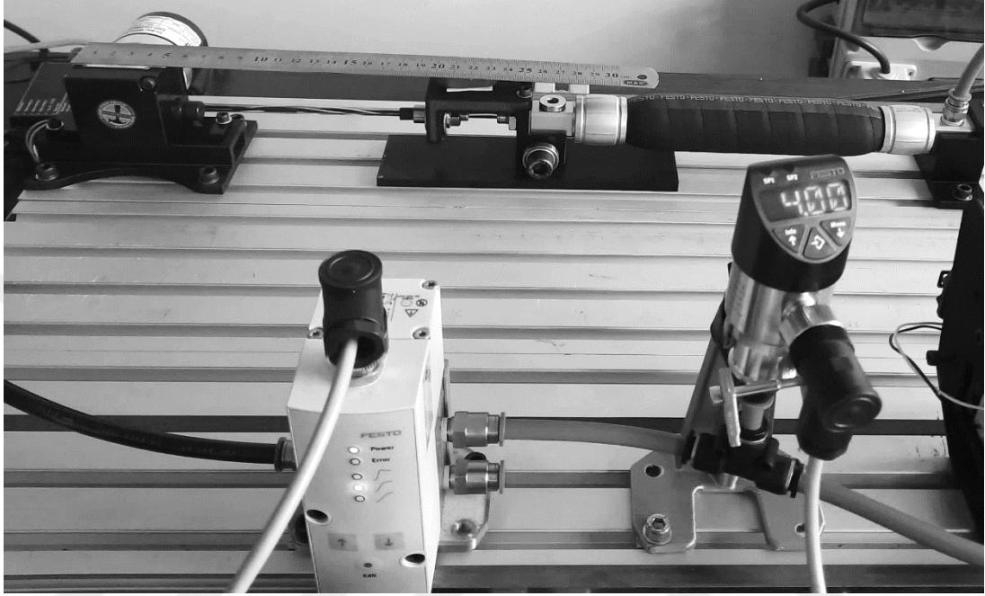
Şekil 3.4. PYK'nın statik karakteristiği için kurulan deney düzeneği.
