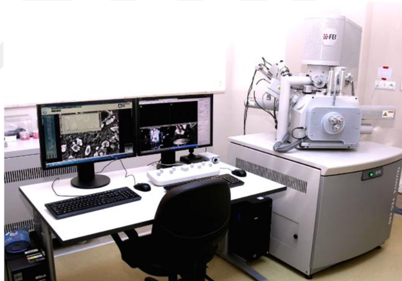
Şekil 3.10. Quanta 650 Field Emission SEM model taramalı elektron mikroskobu
