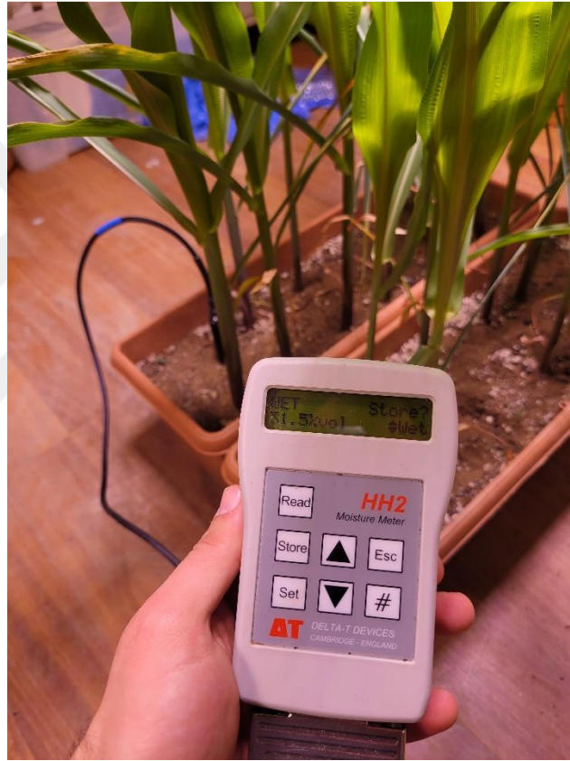
Şekil 3.2. Toprak nem ölçer cihazı ile tarla kapasitesinin ölçülmesi (%30 tarla kapasitesini göstermektedir. Sulama sonrası ölçüm yapılmıştır).
