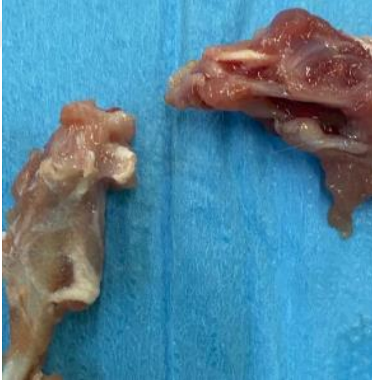
Şekil-30: Biyomekanik deneyde intratendinöz bölgeden kopmuş olan örneğin görüntüsü
