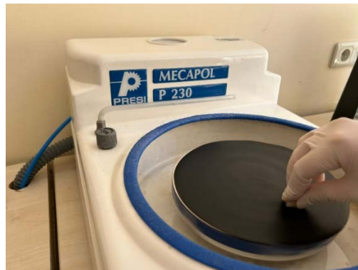
Resim 4: Yüzey standardizasyonu sağlamak için kullanılan parlatma cihazı
