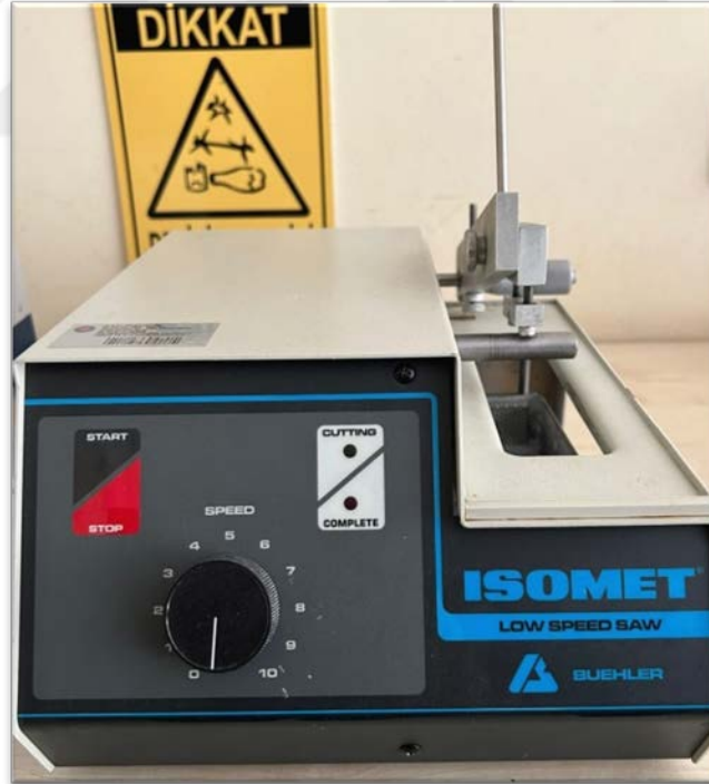
Resim 2: Düşük hızlı hassas kesme cihazı
