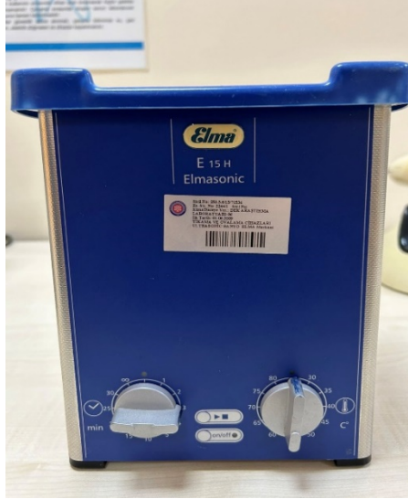
Resim 5: Ultrasonik temizleme cihazı
