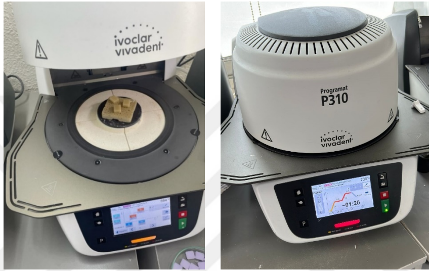
Resim 3: Blokların kristalizasyon işlemine tabi tutulduğu sinterleme fırını
