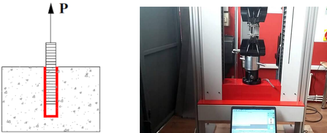
Şekil 3.3. Çekip çıkarma deneyi ile ilgili görseller (Sansak M.F., 2019).
