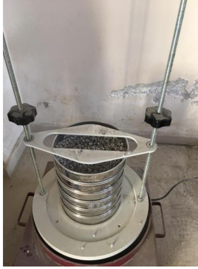
Şekil 4. 4. Perlit agregası eleme düzeneği.
