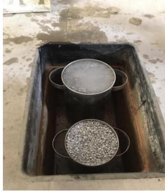
Şekil 4. 6. Özgül ağırlığı ve birim ağırlığı bulunan iri ve ince perlit agregaları.
