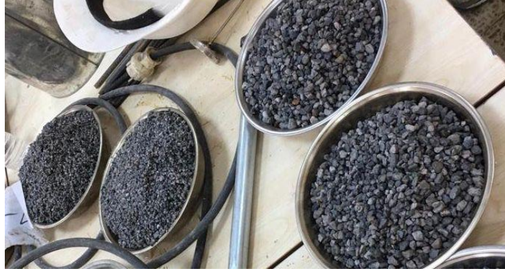
Şekil 4. 8. Suda bekletilen perlit agregaları.
