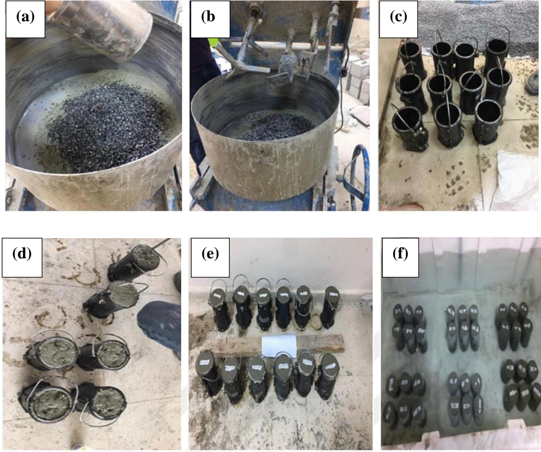
Şekil 4. 10. Beton numune ön deney aşamaları.
