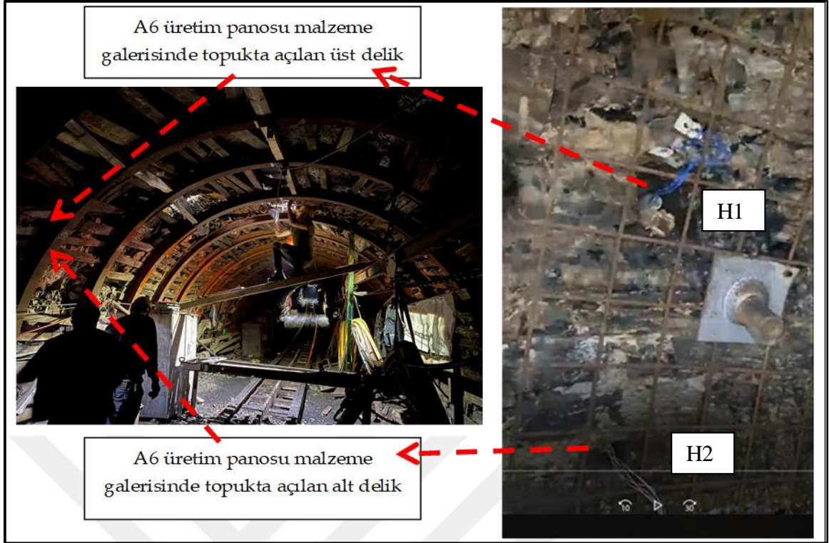
Şekil 3.15. TKİ-GLİ-Ömerler yeraltı maden işletmesi A6 üretim panosu malzeme galerisinde kurulan ön ölçüm istasyonu (H1: Üst ölçüm deliği, H2: Alt ölçüm deliği)
