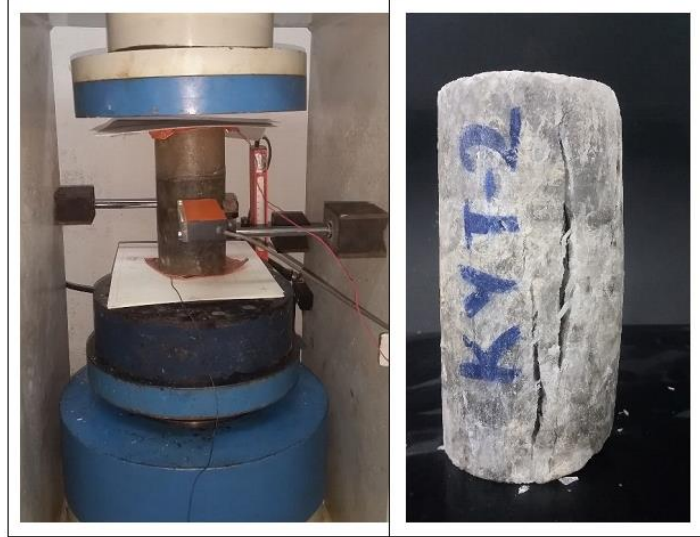
Şekil 2.3. Kaya tuzunun tek eksenli basınç altında gerilme, birim deformasyon ve elektriksel direnç davranışının belirlenmesine ait tipik bir deney (Özkan ve ark., 2018)
