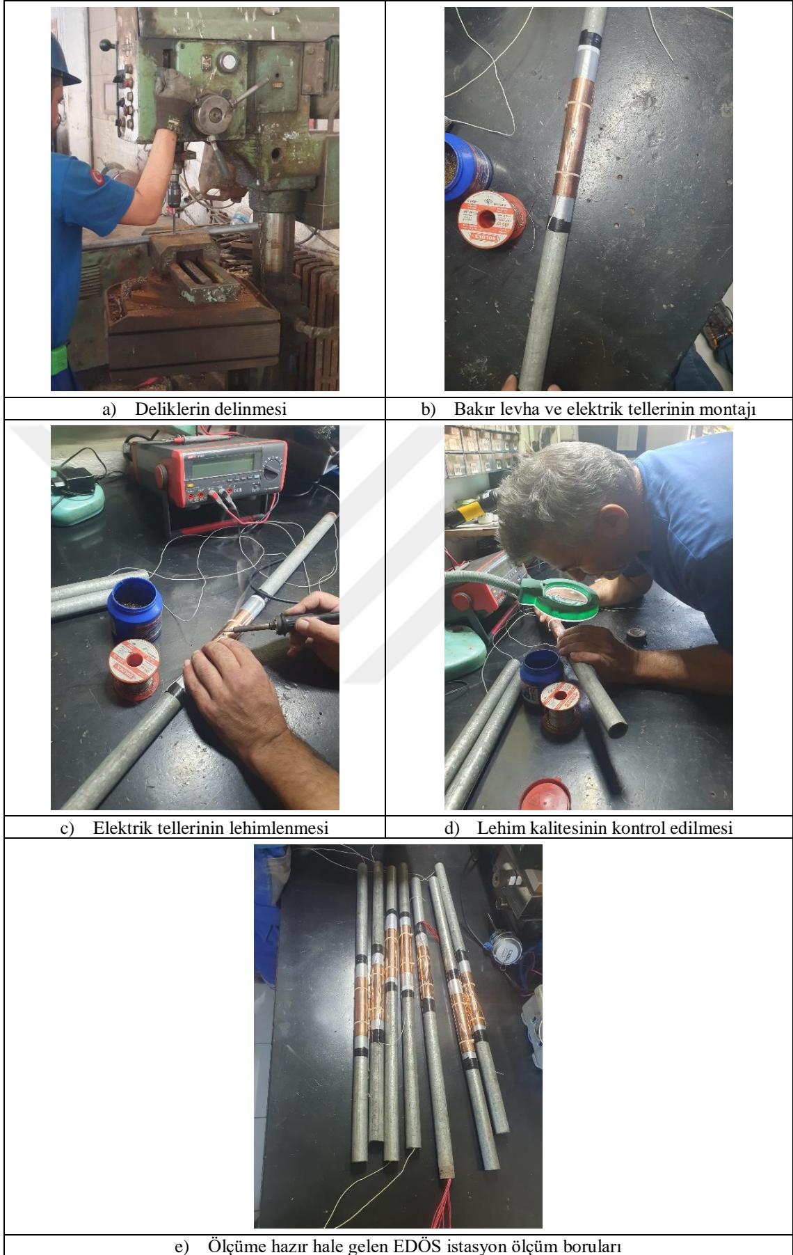
Şekil 3.22. A7 panodaki uygulamalar için ölçüm borularının hazırlanması süreci
