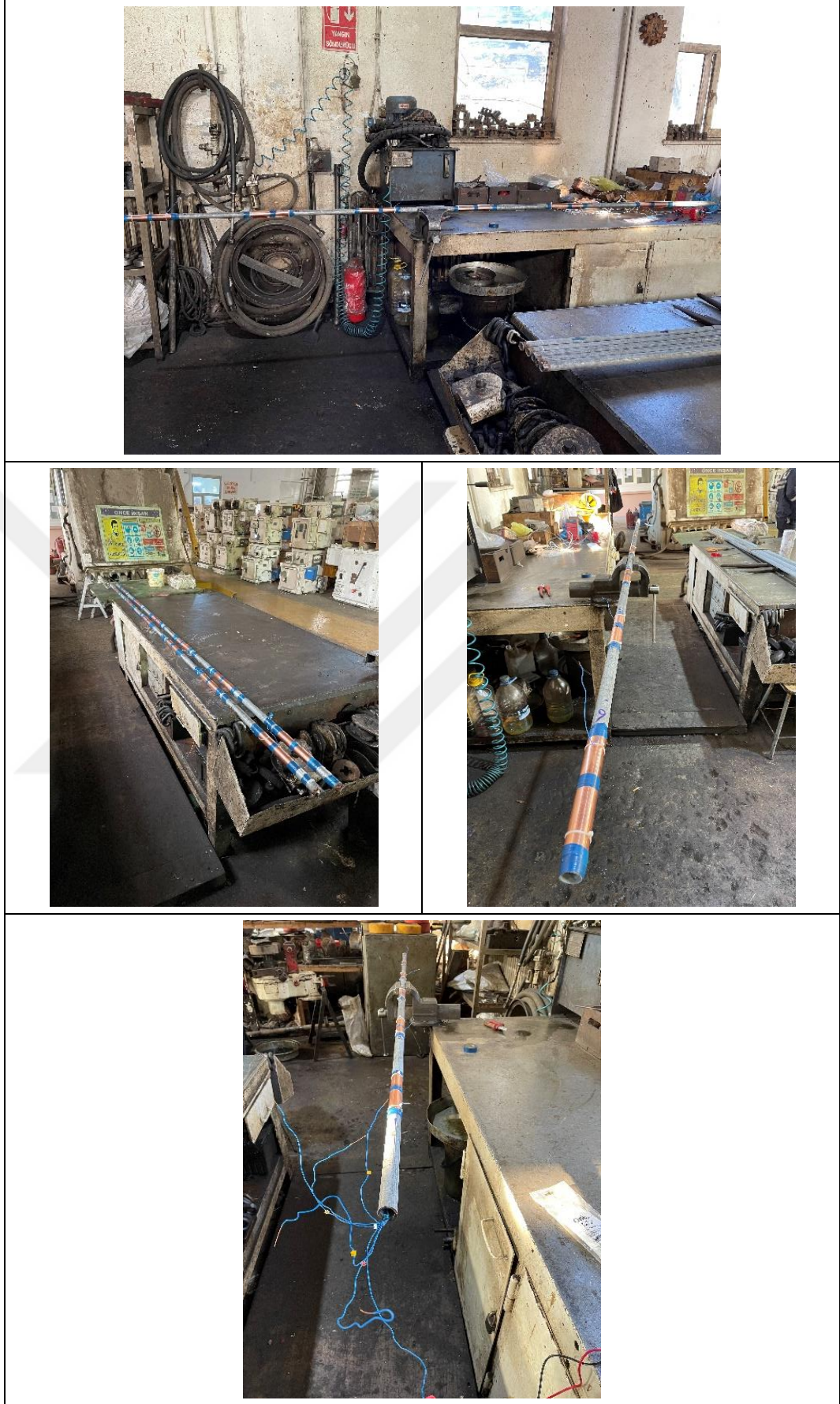
Şekil 3.12. Saha çalışmalarında kullanılan elektriksel ölçüm düzeneğinin (EDÖS) TKİ-GLİ Atölyesindeki imalatı
