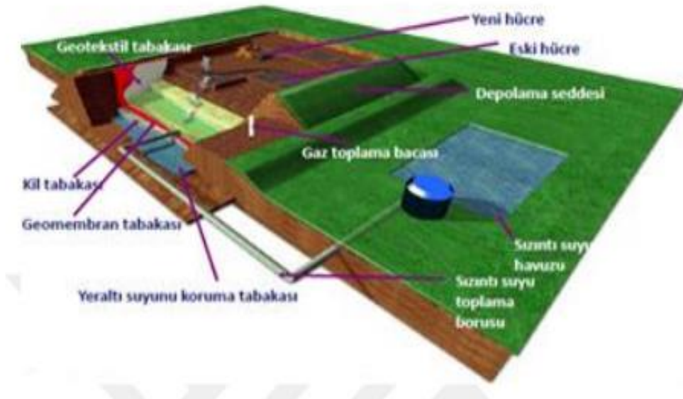
Şekil 2.2: Bir atık düzenli depolama tesisi yapısı.
