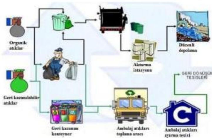
Şekil 2.4: Atıkların kaynakta ayrıştırılması ve geri kazanımının şematik gösterilişi.
