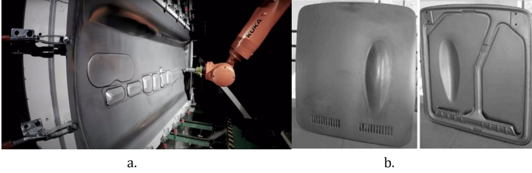
Resim 1.5. a. Nissan otomobil fabrikası karşı destekli takım yöntemi ile ASŞ (Autotv, 2020). b. Amino tarafından Honda için yapılan S800 kaputu (Maki, 2006).
