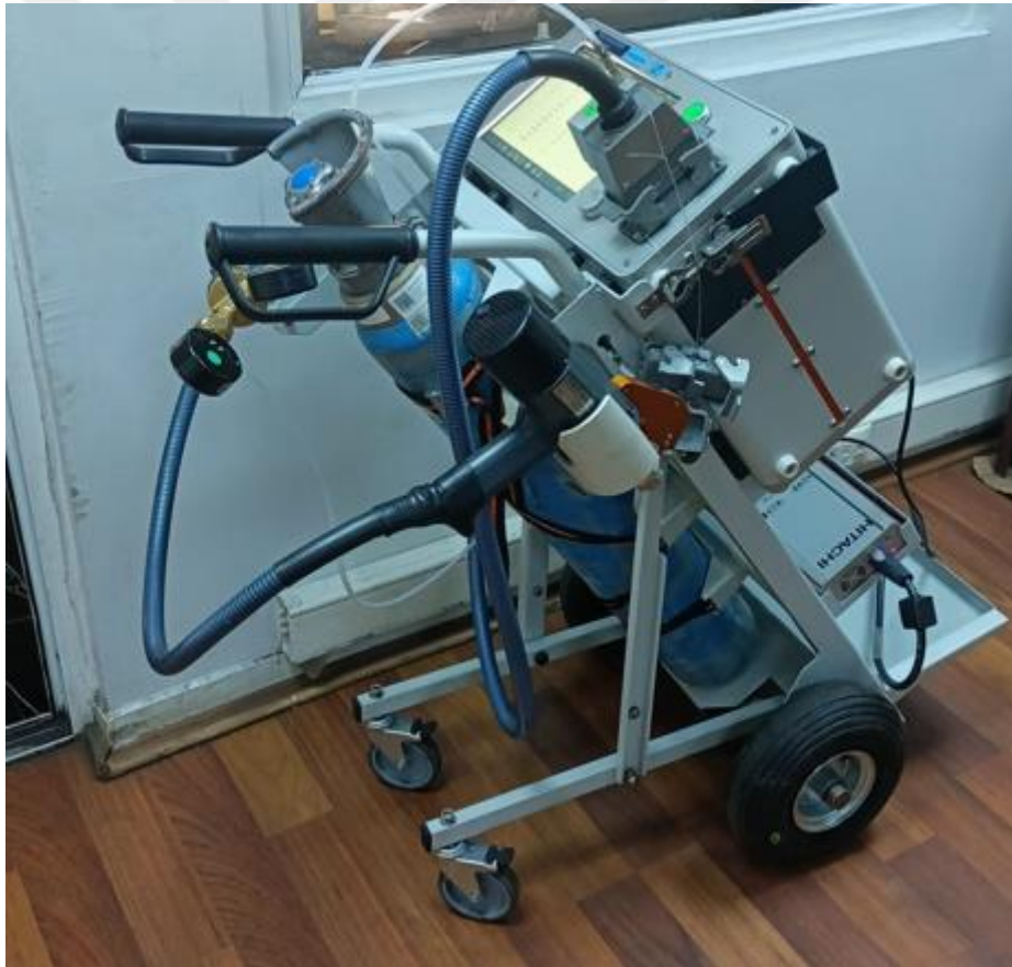
Resim 3.1. 430 Paslanmaz çeliğin karakterizasyonu belirlemek için kullanılan endüstriyel spektrometre cihazı
