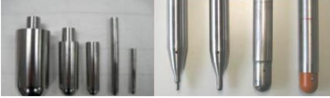
Resim 1.3. Farklı çaplarda tasarlanmış takım geometrileri (Hirt, 2004)
