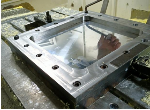
Resim 3.17. a) Alt tutucu fikstüre alt destek kalıbının geçirilmesi, b) Üst fikstürünüzzerine kapatılması, c) İşleme sacının yerleştirilmesi ve kalıbın vidalarla sabitlenmesi
