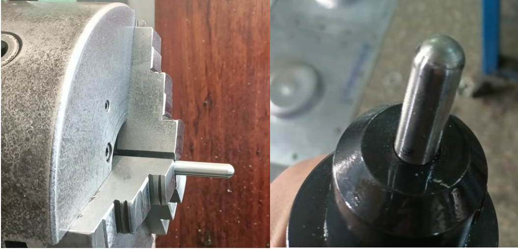
Resim 3.5. Torna makinesinde işlenmiş \varnothing 12 mm radius 5 mm küresel şekillendirici takım
