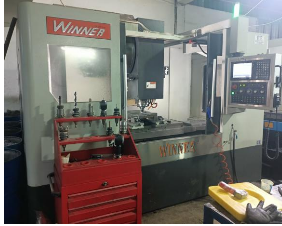
Resim 3.4. Winner VMC 750 Model CNC dikey işleme tezgahı
