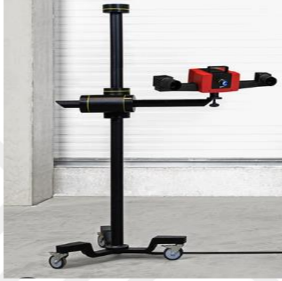
Resim 3.7. Ölçüm ünitesi Atos Comact Scan 2M
