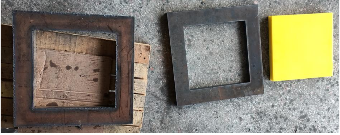
Resim 3.12. İşleme payı bırakılarak kesimleri yapılmış kalıp parçaları
