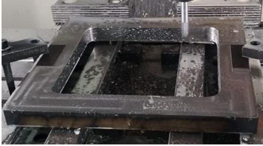
Resim 3.16. Alt tutucu fikstürün iç ölçülerinin kestamid kalıba göre işlenmesi
