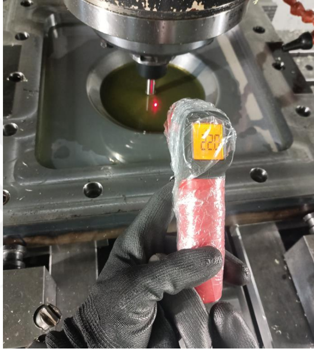
Resim 3.8. Uni-T UT300A+ Infrared lazerli termometre ile yağ sıcaklık ölçümü
