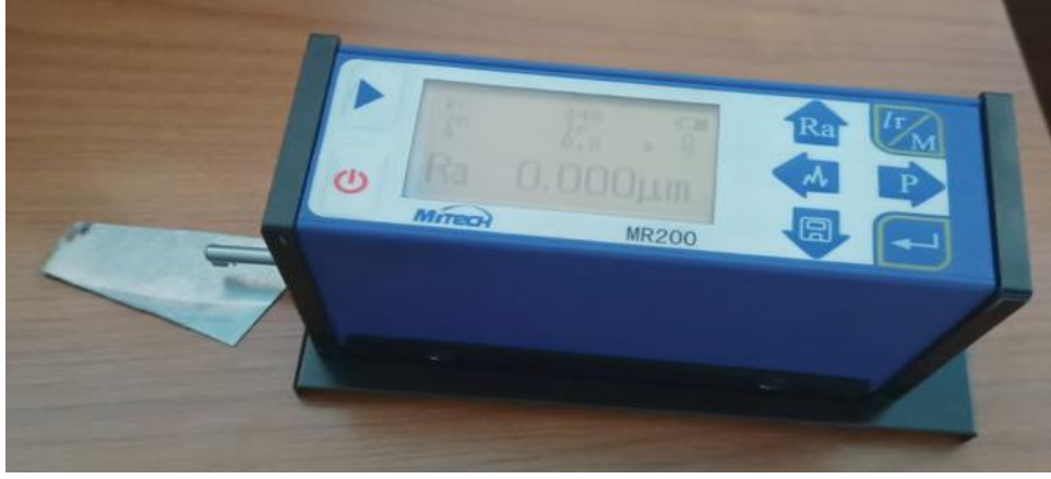
Resim 3.9. MITECH MR200 profilometre cihazı
