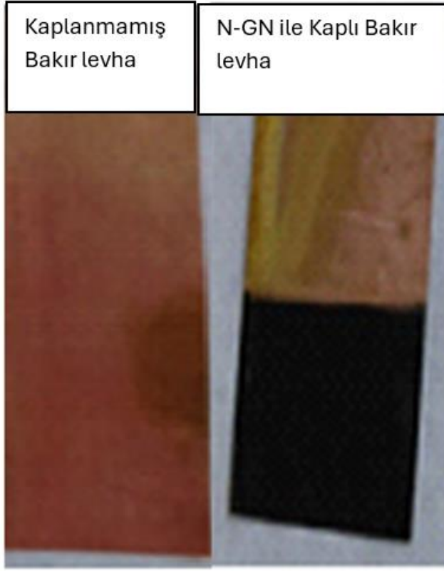
Şekil 3.1. Kaplanmamış Bakır Levha ve N-GN ile Kaplı Bakır Levha.
