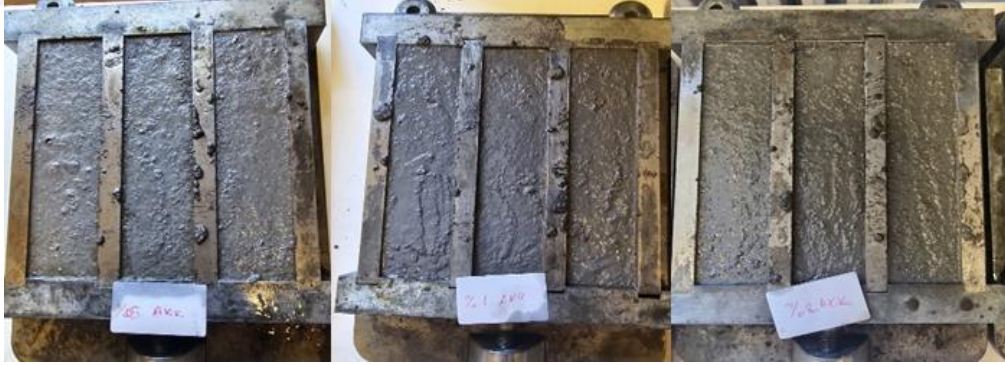
Görsel 5.5. %0,5; 1 ve 2 oranlarında AKK eklenmiş harç örnekleri
