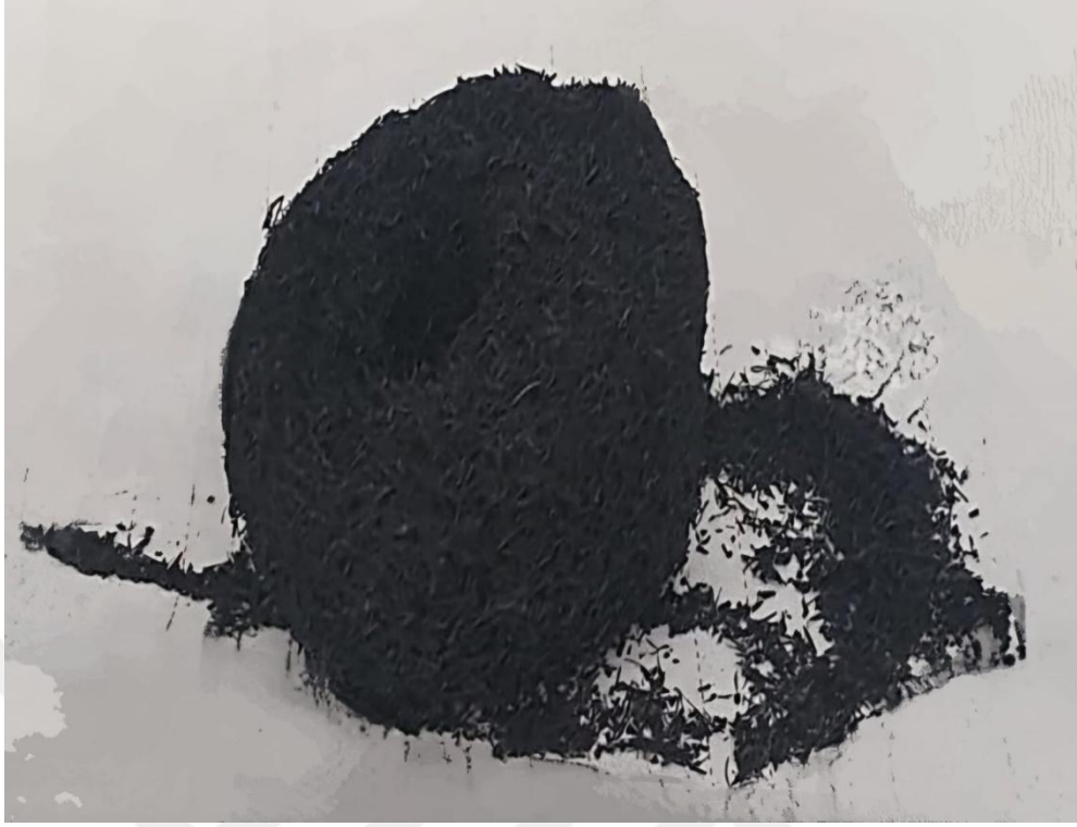
Görsel 5.2. Laboratuvar ortamında üretilen biyokömür
