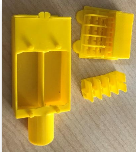
Şekil 12. 3D printer’la üretilen Nefes Toplama aparatı ve içerisindeki filtrelerin görüntüsü
