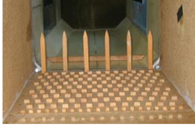
Şekil 7. Rüzgar tüneline bariyer, girdap üreticiler ve pürüzlülük elemanları
