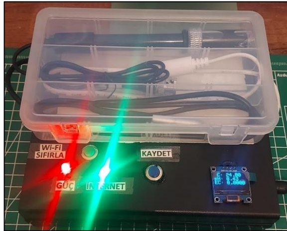
Şekil 3. 9. EC sonuçlarını buluta gönderen elektronik sistem
