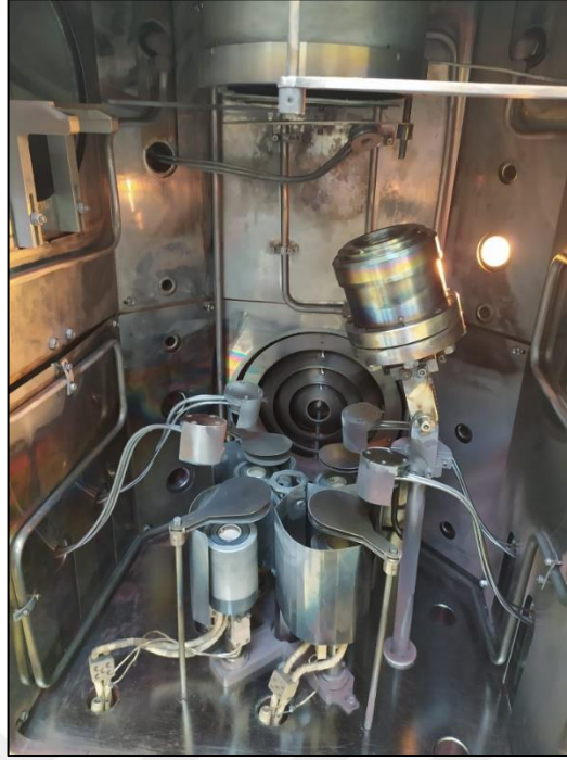
Şekil 3.1. Vaksis Midas 4T1M sistemi iç tasarımı
