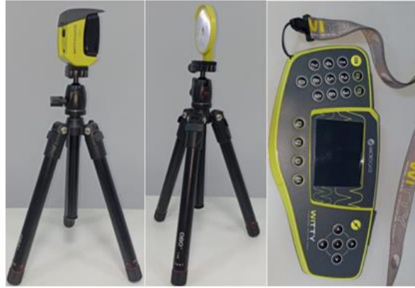
Şekil 3.8. Yön değıştirme ve Sprint testlerinde Kullanılan Fotosel Sistemi (Yazarın arşivinden)
