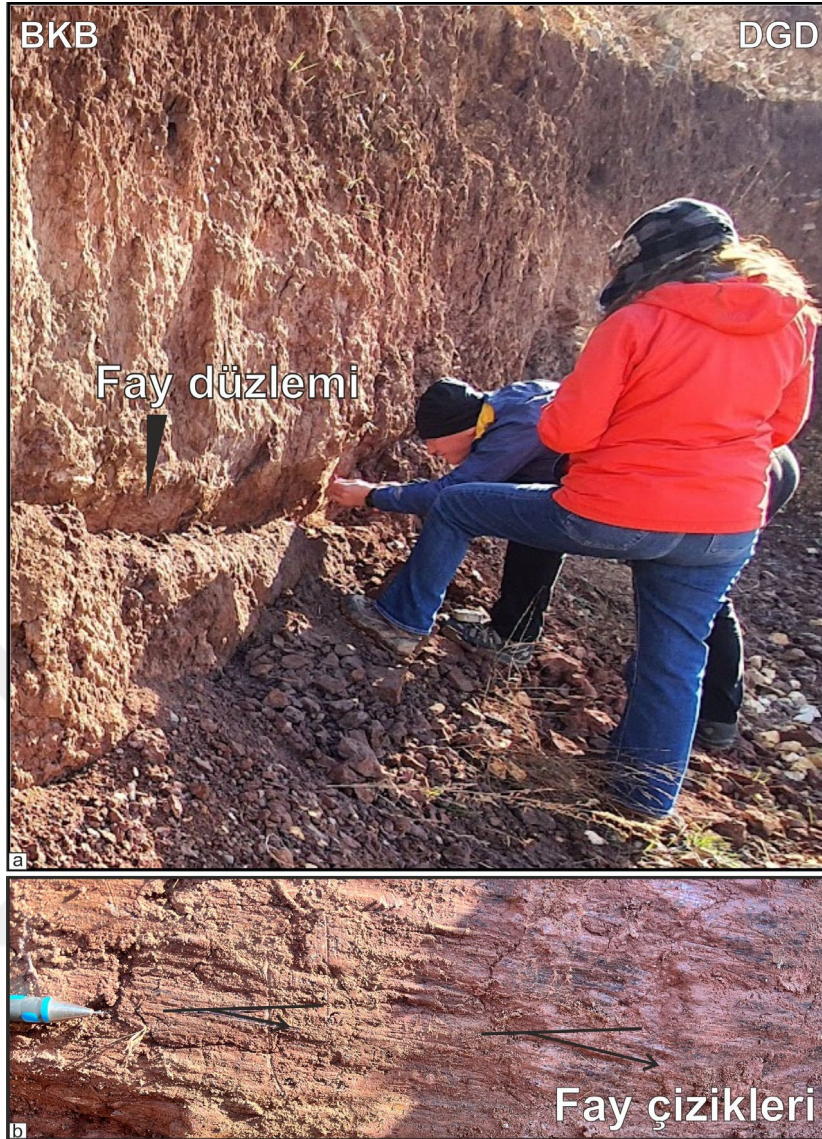
Şekil 3.2. Paleosismoloji çalışmaları öncesinde yapılan kinematik analiz çalışmaları.
