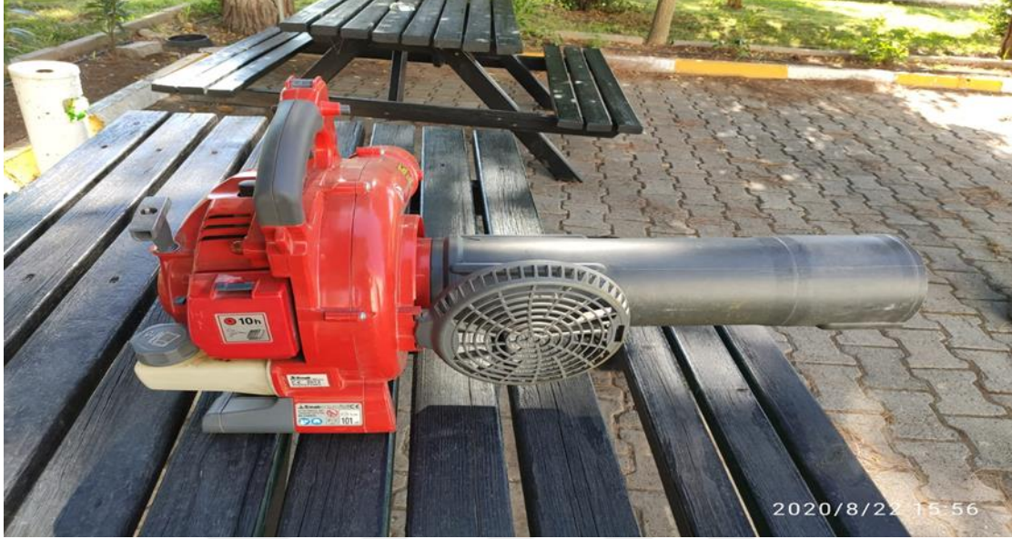
Şekil 3.1. Çalışmalarda kullanılan Vakumlu Böcek Toplama Aleti [D-Vac]
