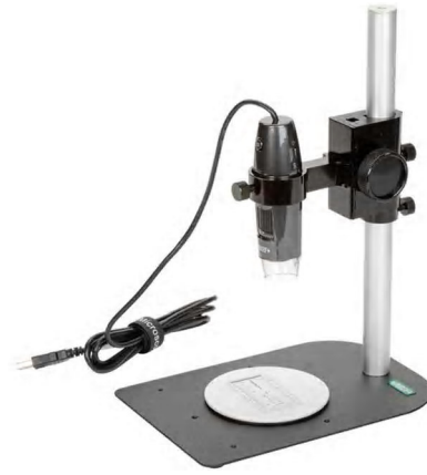
Şekil 3.4 Kaynak makroları için kullanılan mikroskop
