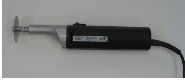
Şekil 3. Kemiklerden kesit elde etmek için kullanılan elektrikli testere
