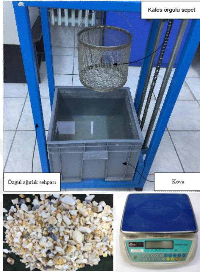
Şekil 6.7. Kaba agregat, kafes örgülü sepet ve özgül ağırlık sehpası
