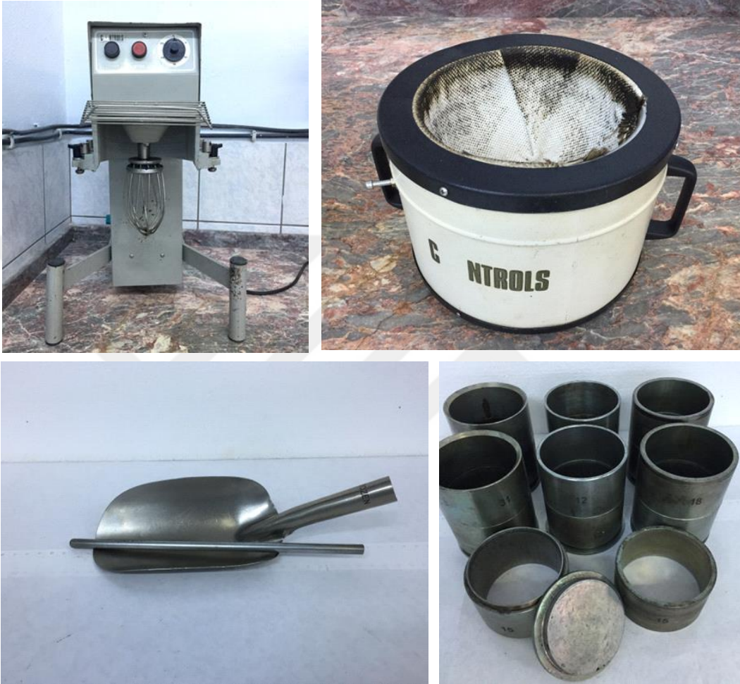
Şekil 6.10. Mikser, mikser ısıtma kabı, kürek ve şişleme çubuğu, numune kalıpları
