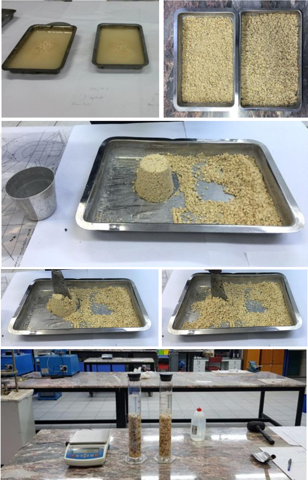
Şekil 6.8. İnce agreganın özgül ağırlığının bulunması
