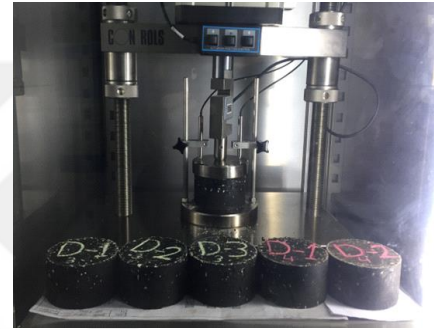
Şekil 7.10. Sünme ve yükleme çerçevesine yerleştirilmiş numuneler
