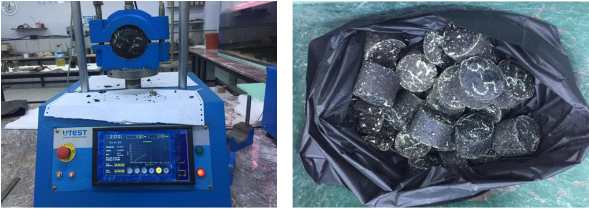
Şekil 6.17. Marshall test cihazı ve kırılmış numuneler
