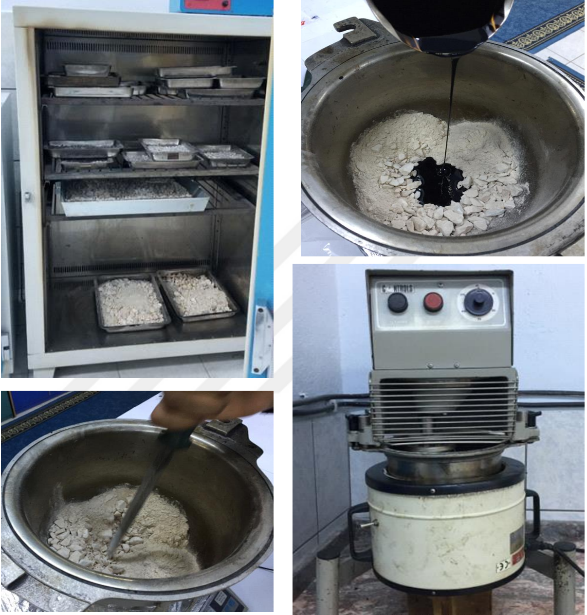
Şekil 6.14. Agrega ve bitüm karışımının hazırlanması
