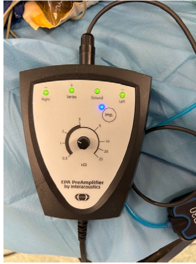
Şekil 18. Elektrot cilt impedans ölçümü için kullanılan amplifier
