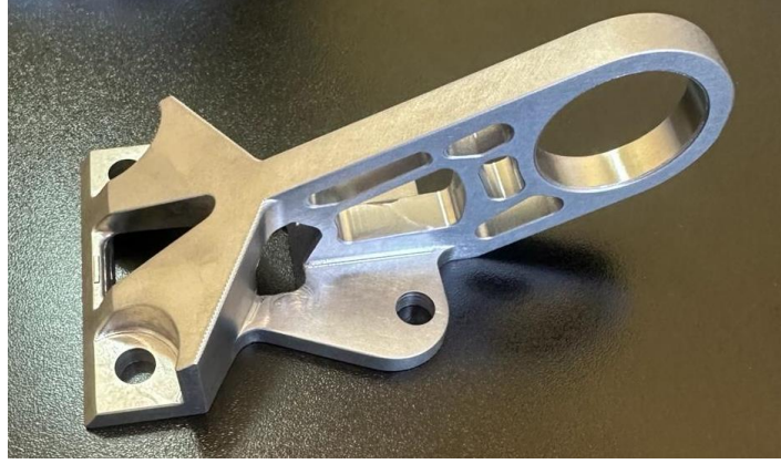
Şekil 3.54. Talaşlı İmalat ile Üretilen 4140 Yeniden Modellenmiş Braket
