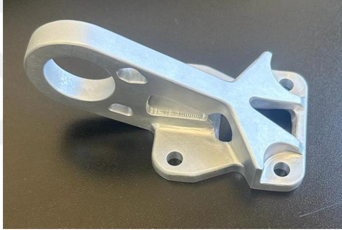
Şekil 3.55. Talaşlı İmalat ile Üretilen 6061 Yeniden Modellenmiş Braket
