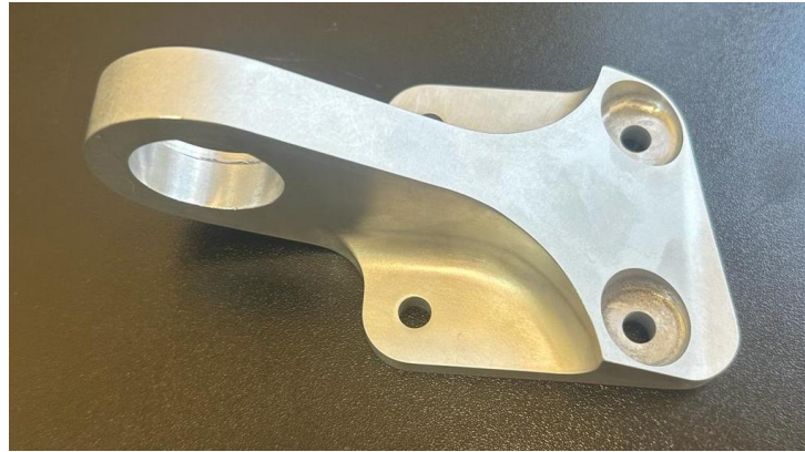
Şekil 3.53. Talaşlı İmalat ile Üretilen 6160 Orijinal Braket
