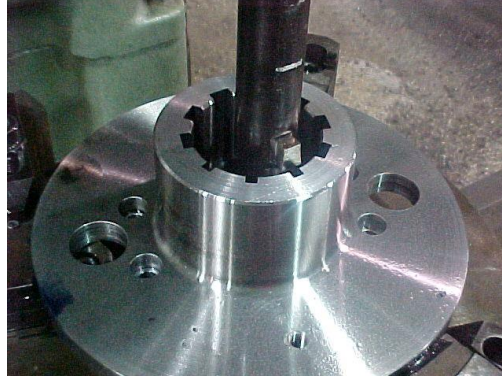
Şekil 3.8. Broşlama İşlemi Esnasında Çekilen Bir Görüntü
