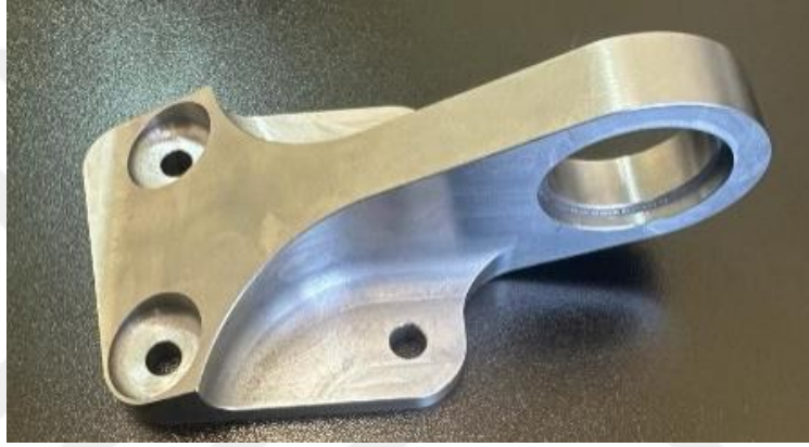
Şekil 3.52. Talaşlı İmalat ile Üretilen 4140 Orijinal Braket
