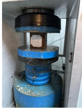
Şekil 3.12. Sertleşmiş beton basınç dayanım deneyi.
