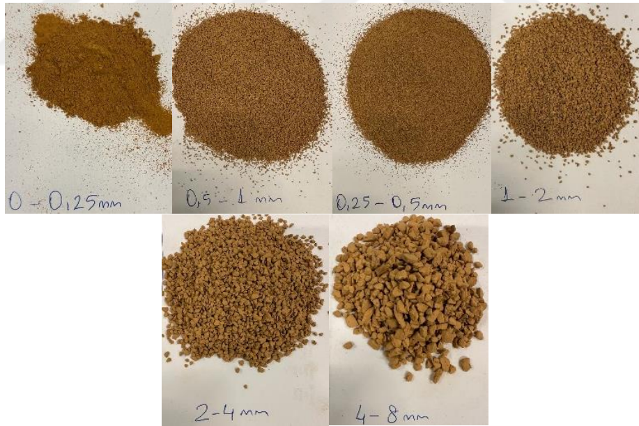
Şekil 3.3. Tuğla atıklarının laboratuvar tipi kırıcı ile küçültüldükten sonra farklı eleklerde ayrıştırılmış görselleri.
