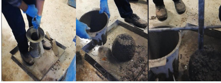
Şekil 3.9. Bazı beton harçlarının çökme deneyi sonrasındaki görüntüleri.
