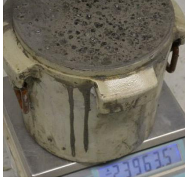
Şekil 3.10. Taze beton birim hacim ağırlığı deneyi.
