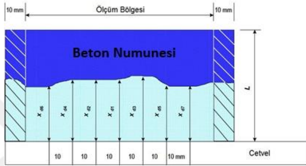
Şekil 3.18. Klor geçirimsizliği ölçümü için kullanılan metot.
