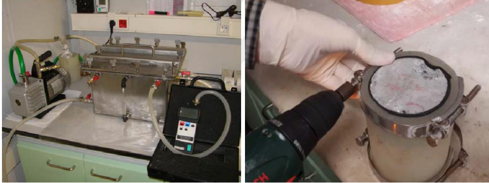
Őekil 3.13. Vakum iřlemi deney düzeneđi ve numunelerin silikon kauçuktan yapılmıř deney düzeneđine yerleřtirilmesi.
