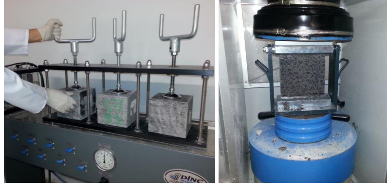
Şekil 3.20. Basınçlı su emme deneyi için numunenin deney düzeneğine yerleştirilmesi ve numunenin basınçlı su uygulanan yüzeye dik şekilde ortasından yarılması.
