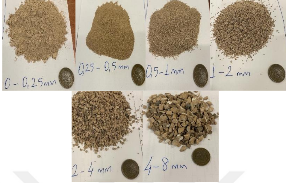
Şekil 3.5. Seramik atıklarının laboratuvar tipi kırıcı ile küçültüldükten sonra farklı eleklerde ayrıştırılmış görselleri.
