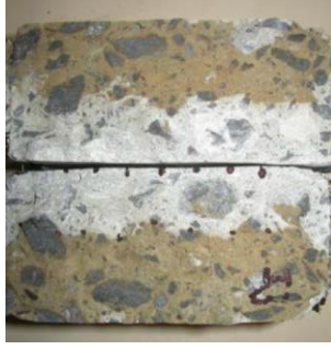
Şekil 3.17. Deneye maruz bırakılıp yarıldıktan sonraki numuneye ait görsel.
