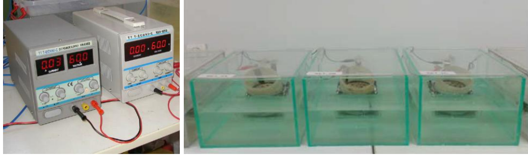
Şekil 3.15. DC Güç kaynakları ve NT BUILD 492 standardına göre deneyde kullanılan havuzları.
