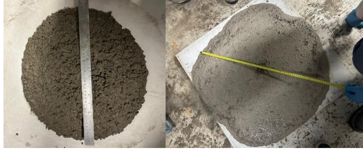
Şekil 3.9. Beton harçlarının yayılma deneyi sonrasındaki görüntüleri.
