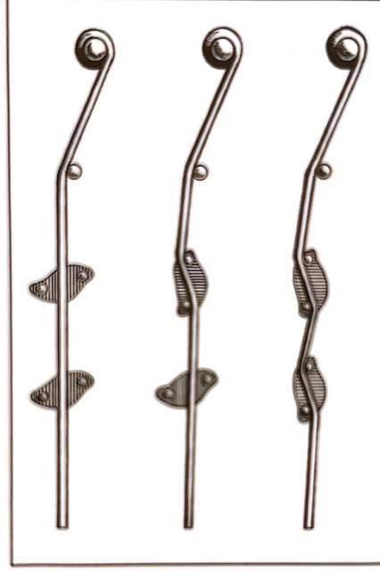
Şekil 1.17: Çift Kademeli Pedallı Arpta Çatallı Disk Mekanizması
