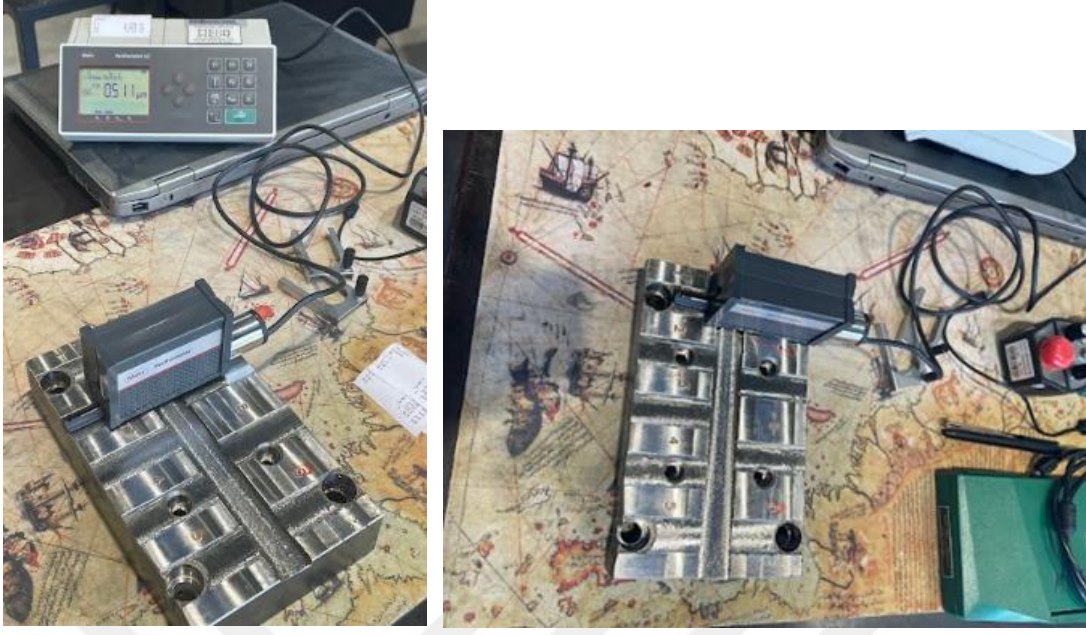
Şekil 3.9. Yüzey pürüzlülüğü ölçümü
