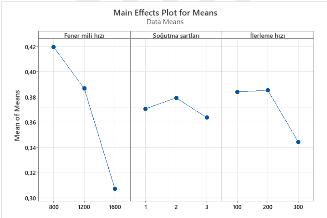
Şekil 4.7. Frezeleme parametre seviyelerinin yüzey pürüzlülüğüne etkisi
