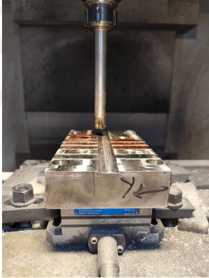
Şekil 3.6. Deneylerde kesme kuvveti ölçüm düzeneği
