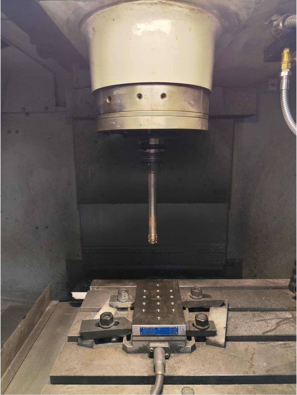
Şekil 3. 5 Kesme kuvvet ölçümlerinin yapıldığı dik işlem merkezi
