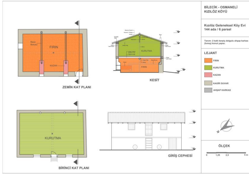
Şekil 3.54 Kızılöz Köyünde bir biberlik yapısının plan, kesit ve cephe çizimleri.
