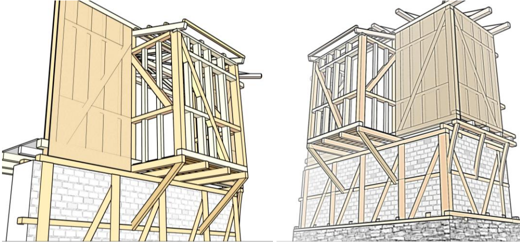
Şekil 3.26 Hela çıkmasının farklı açılardan 3 boyutlu görünüşü.
