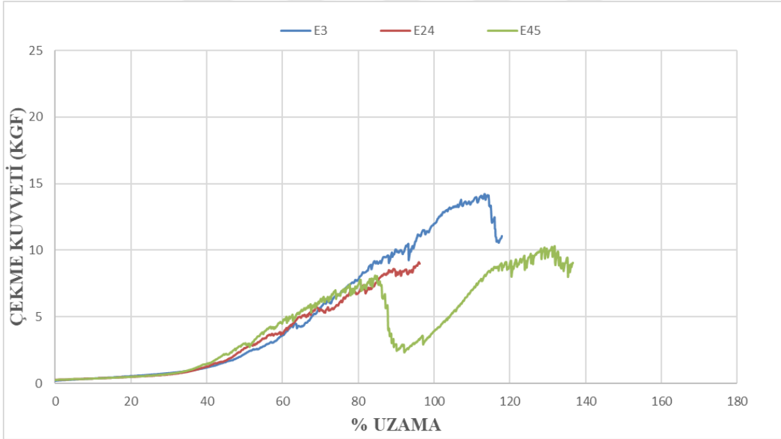
Şekil 3.31: E3-E24-E45 kumaşlarının zemin örgüsü sıra sayısı değişimi sonucu elde edilen çekme kuvveti – uzama grafiği
