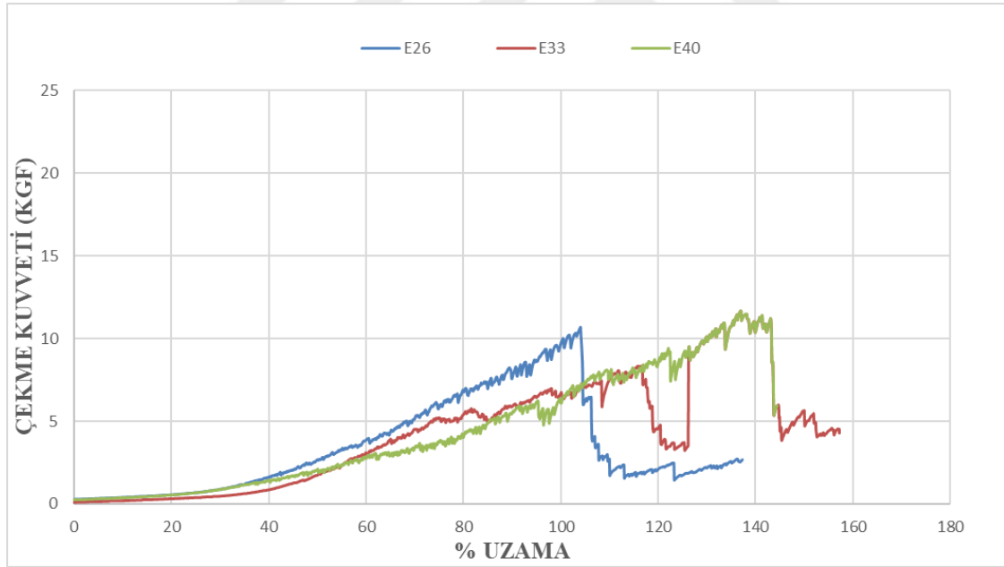
Şekil 3.19: E26-E33-E40 kumaşlarının ilmek uzunluğu değişimi sonucu elde edilen çekme kuvveti – uzama grafiği
