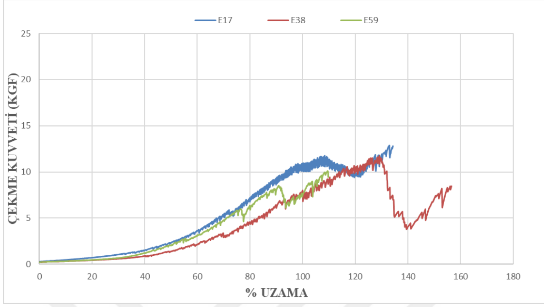
Şekil 3.45: E17-E38-E59 kumaşlarının zemin örgüsü sıra sayısı değişimi sonucu elde edilen çekme kuvveti – uzama grafiği
