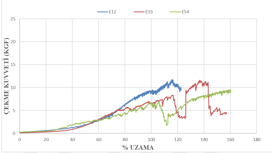
Şekil 3.40: E12-E33-E54 kumaşlarının zemin örgüsü sıra sayısı değişimi sonucu elde edilen çekme kuvveti – uzama grafiği
