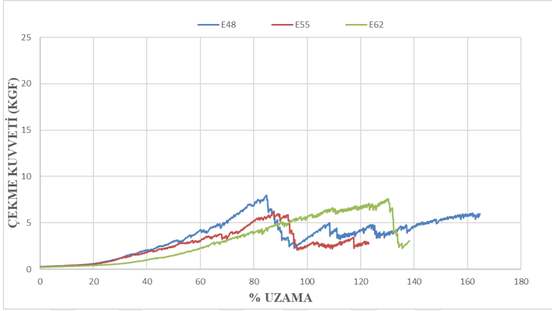
Şekil 3.27: E48-E55-E62 kumaşlarının ilmek uzunluğu değişimi sonucu elde edilen çekme kuvveti – uzama grafiği
