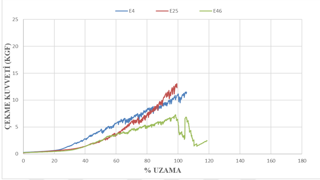
Şekil 3.32: E4-E25-E46 kumaşlarının zemin örgüsü sıra sayısı değişimi sonucu elde edilen çekme kuvveti – uzama grafiği
