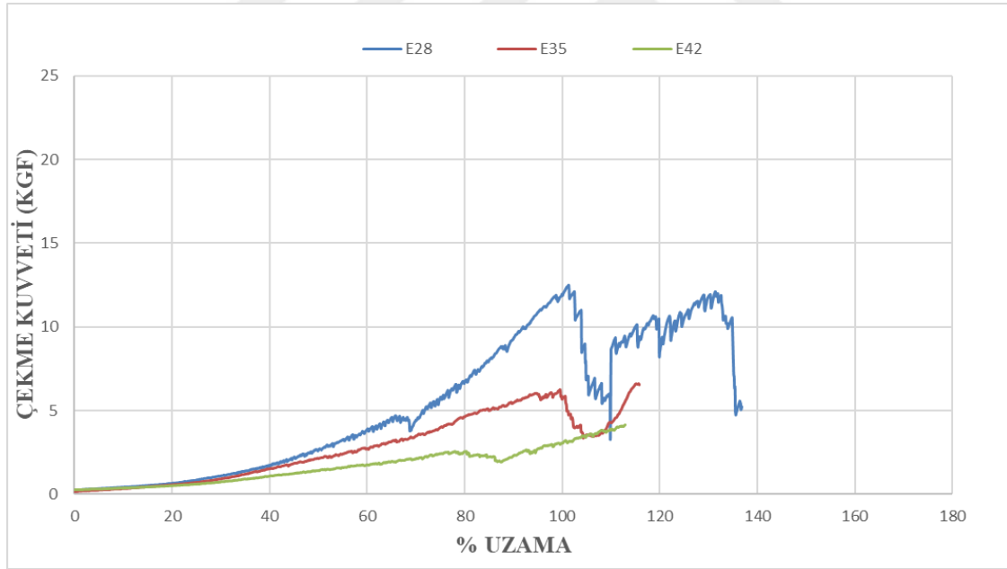
Şekil 3.21: E28-E35-E42 kumaşlarının ilmek uzunluğu değişimi sonucu elde edilen çekme kuvveti – uzama grafiği
