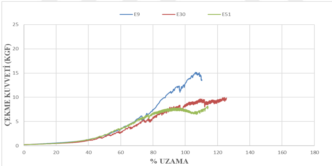
Şekil 3.37: E9-E30-E51 kumaşlarının zemin örgüsü sıra sayısı değişimi sonucu elde edilen çekme kuvveti – uzama grafiği
