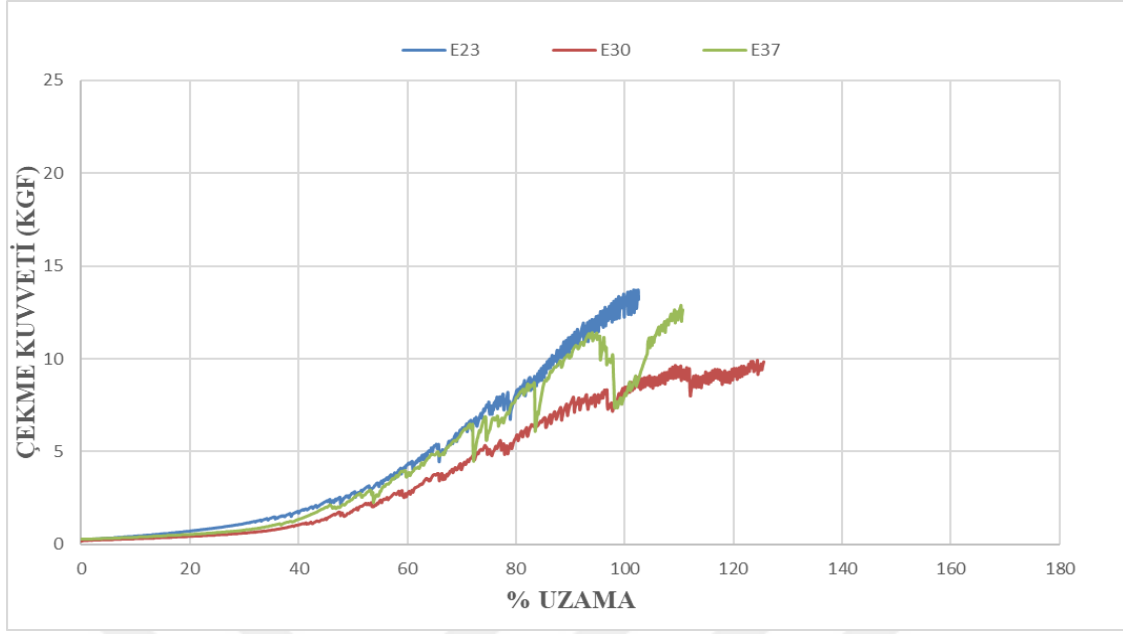
Şekil 3.16: E23-E30-E37 kumaşlarının ilmek uzunluğu değişimi sonucu elde edilen çekme kuvveti – uzama grafiği
