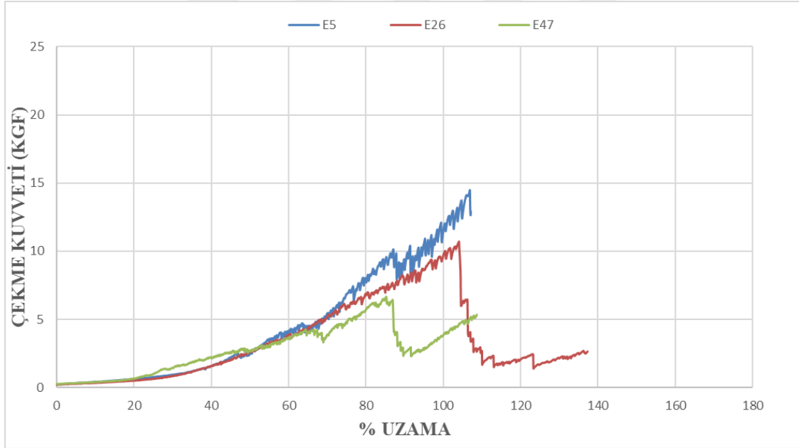
Şekil 3.33: E5-E26-E47 kumaşlarının zemin örgüsü sıra sayısı değişimi sonucu elde edilen çekme kuvveti – uzama grafiği
