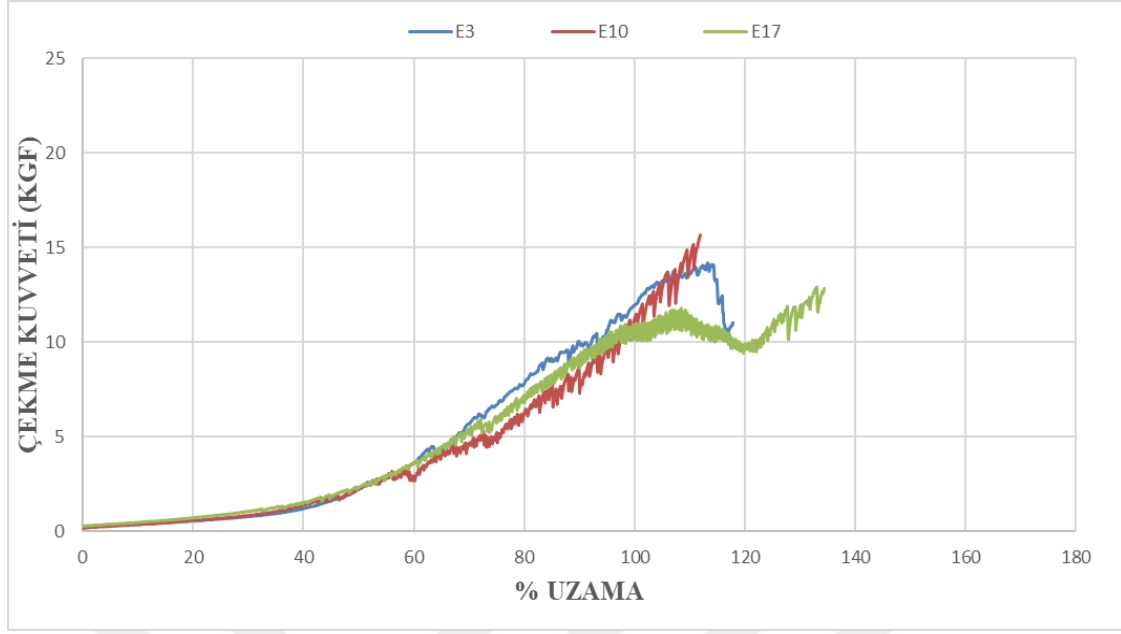
Şekil 3.10: E3-E10-E17 kumaşlarının ilmek uzunluğu değişimi sonucu elde edilen çekme kuvveti – uzama grafiği
