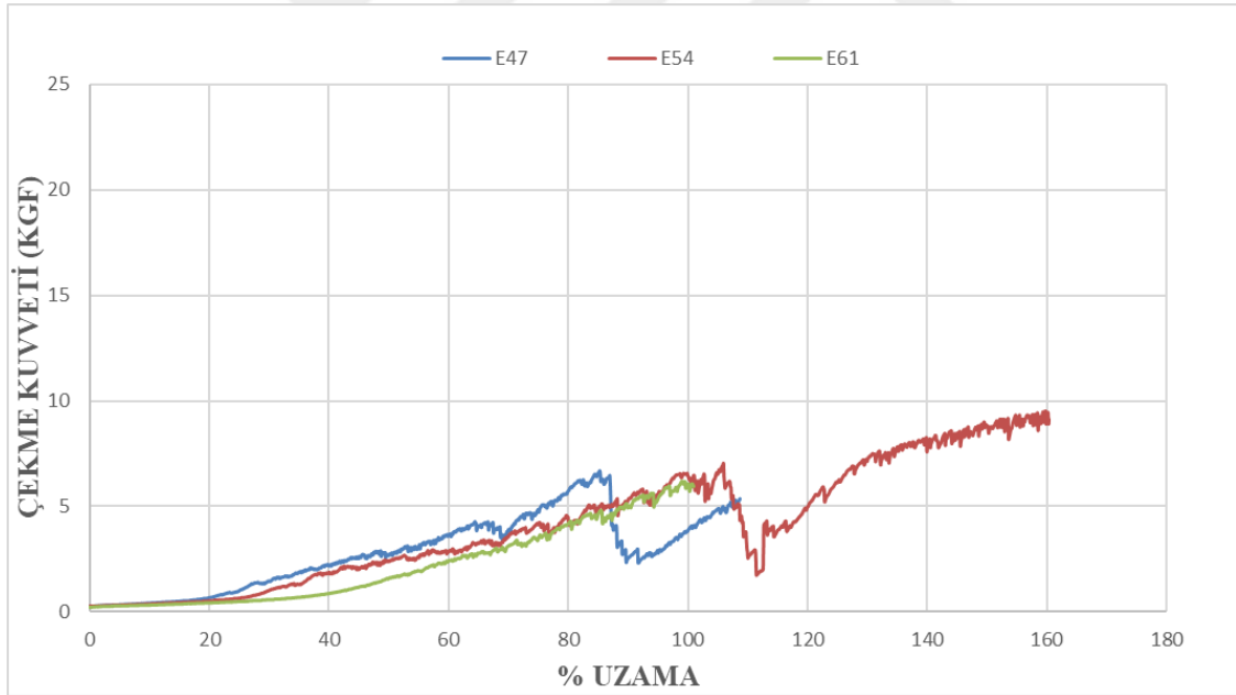
Şekil 3.26: E47-E54-E61 kumaşlarının ilmek uzunluğu değişimi sonucu elde edilen çekme kuvveti – uzama grafiği
