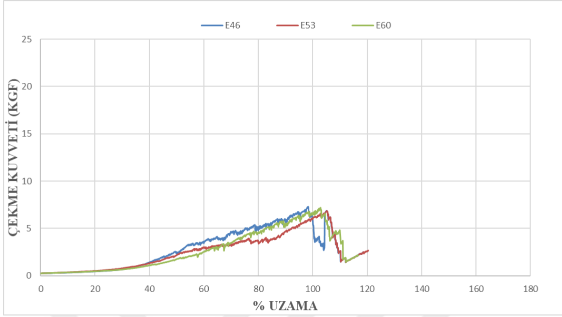
Şekil 3.25: E46-E53-E60 kumaşlarının ilmek uzunluğu değişimi sonucu elde edilen çekme kuvveti – uzama grafiği
