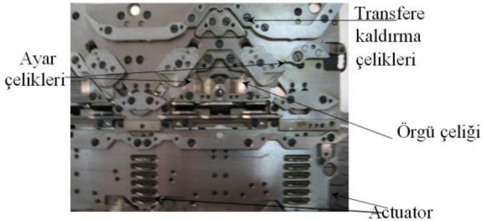
Şekil 1.59: Shima Seiki düz örme makinesinin semerinde bulunan çelikler [49]
