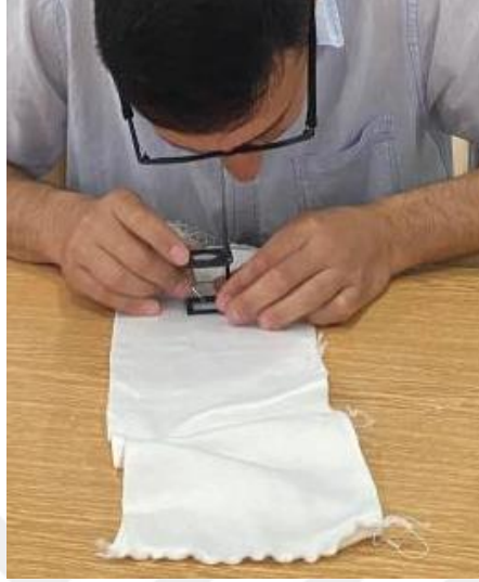
Şekil 2.9: Lup ile satır sıklığı, sütun sıklığı tespiti
