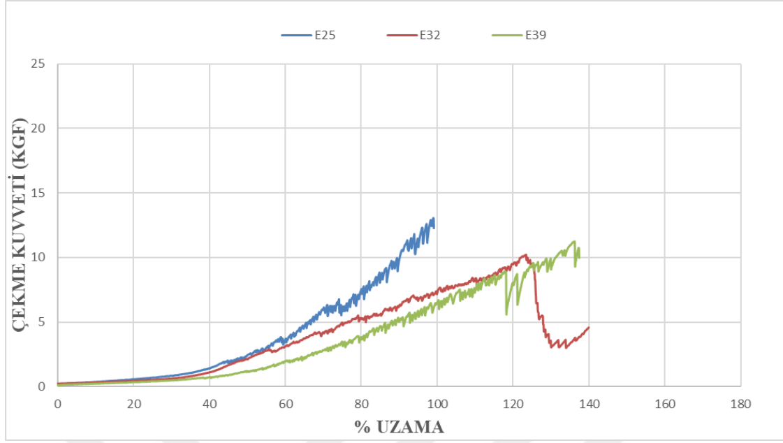
Şekil 3.18: E25-E32-E39 kumaşlarının ilmek uzunluğu değişimi sonucu elde edilen çekme kuvveti – uzama grafiği
