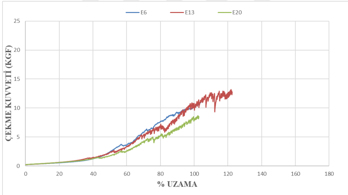
Şekil 3.13: E6-E13-E20 kumaşlarının ilmek uzunluğu değişimi sonucu elde edilen çekme kuvveti – uzama grafiği
