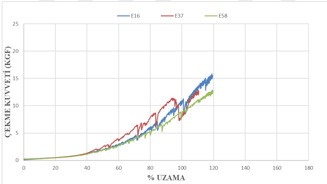
Şekil 3.44: E16-E37-58 kumaşlarının zemin örgüsü sıra sayısı değişimi sonucu elde edilen çekme kuvveti – uzama grafiği
