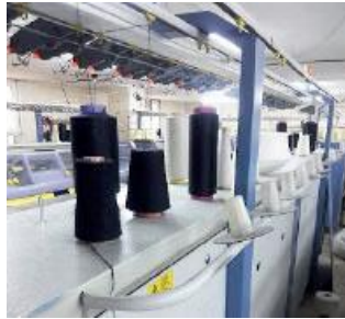
Şekil 1.51: Düz örmede bobin sehpası [41]
