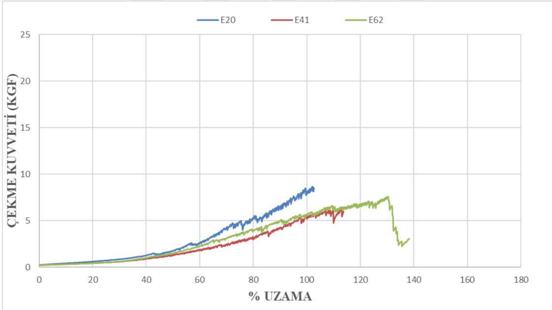
Şekil 3.48: E20-E41-E62 kumaşlarının zemin örgüsü sıra sayısı değişimi sonucu elde edilen çekme kuvveti – uzama grafiği
