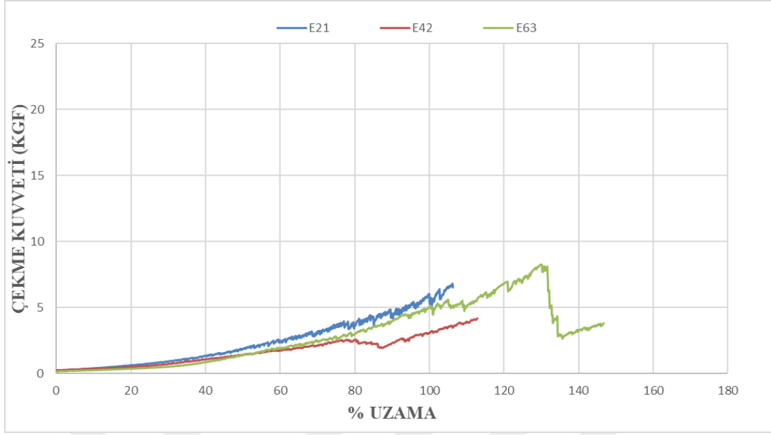
Şekil 3.49: E21-E42-E63 kumaşlarının zemin örgüsü sıra sayısı değişimi sonucu elde edilen çekme kuvveti – uzama grafiği
