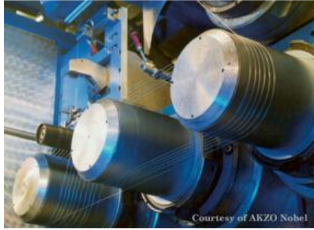
Şekil 1.24: Germe çekme işlemi [31]
