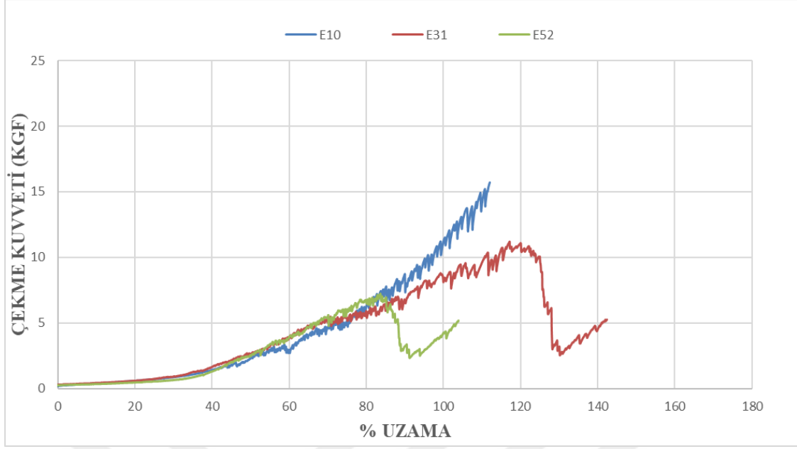
Şekil 3.38: E10-E31-E52 kumaşlarının zemin örgüsü sıra sayısı değişimi sonucu elde edilen çekme kuvveti – uzama grafiği
