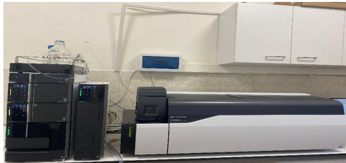
Şekil 5. Adli Bilimler Araştırma Laboratuvarı'nda bulunan ve optimizasyon çalışmalarının yürütüldüğü LC-MS/MS cihazı
