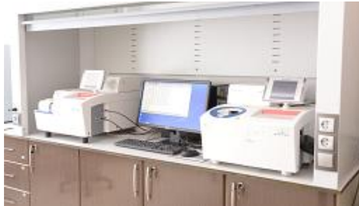
Şekil 2.11. Çalışmada kullanılan Mettler Toledo TGA/DSC2 Star System marka DSC cihazı( Selçuk Üniversitesi İleri Araştırma ve Uygulama Merkezi)
