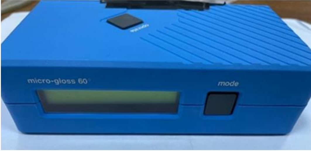
Şekil 2.8. Glossmetre parlaklık ölçüm cihazı
