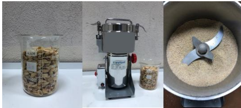
Şekil 2.4. Antep fıstığı kabuklarının öğütülmesi ve elenmesine ait görseller
