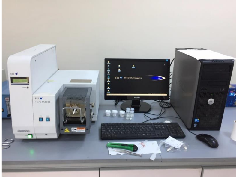
Şekil 2.10. Çalışmada kullanılan Seiko, TG/DTA 6300 model TGA cihazı
