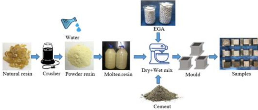
Şekil 3.2. Kompozit malzeme üretim sürecinin akış şeması: Genleştirilmiş cam agregası ve çam reçinesi hazırlanması, karıştırılması, kalıplama, sıkıştırma ve kürlenme aşamaları (Koçyiğit, 2024).
