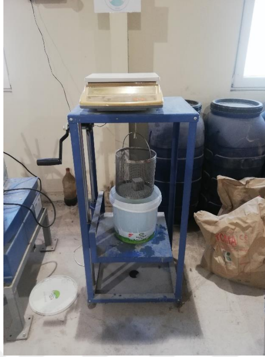
Şekil 3.8 : Arşimet terazi kullanılarak su içindeki harç ağırlık tartımı.
