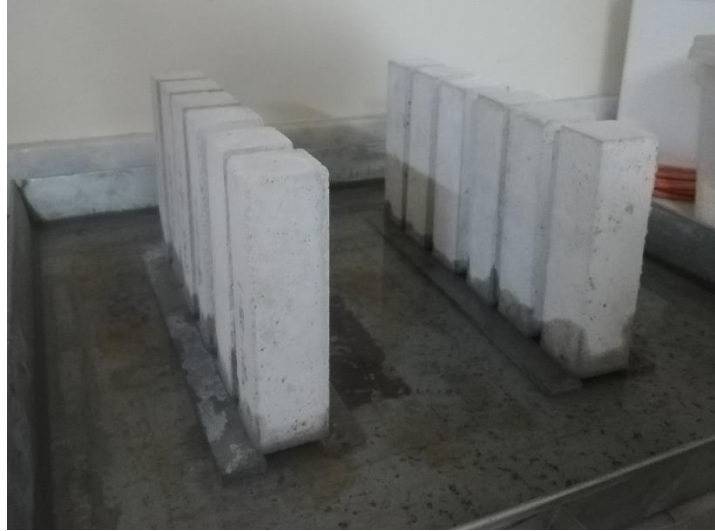
Şekil 4.19 : Kapiller su emme deney süreci.
