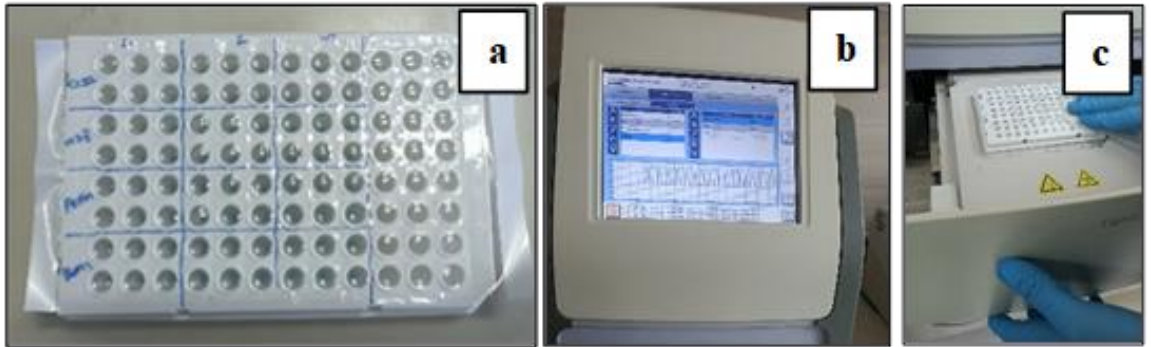
Şekil 3.13. RT-qPCR işlemleri; a) Luna Universal One Step RT qPCR kiti kullanılarak örneklerin RT-qPCR için hazırlanması; b) reaksiyon koşulların light cycler cihazında ayarlanması; c) örneklerin cihaza yerleştirilmesi
