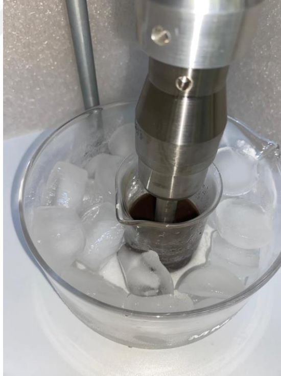
Şekil 3.3. Buz banyosu desteği ile Prob sonikatör işlemi
