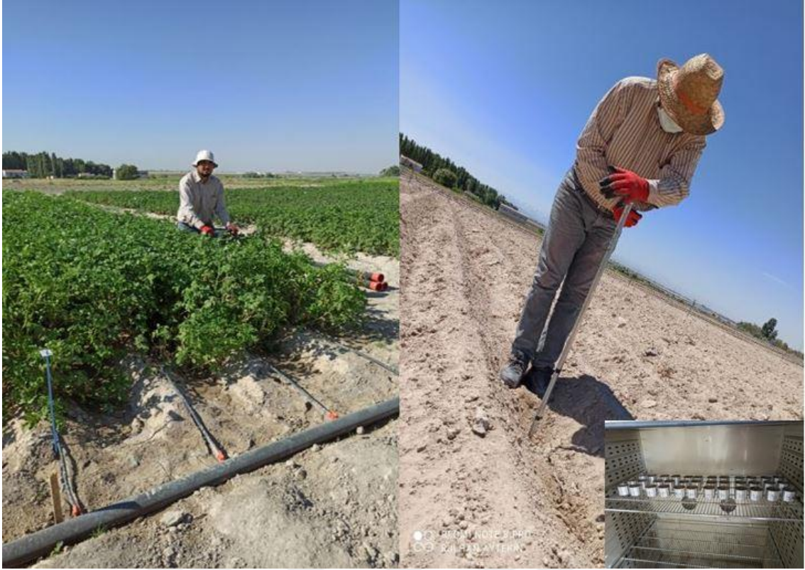
Şekil 3.11. Toprak örneklerinin Eijkelkamp toprak burgusu ile alınması
