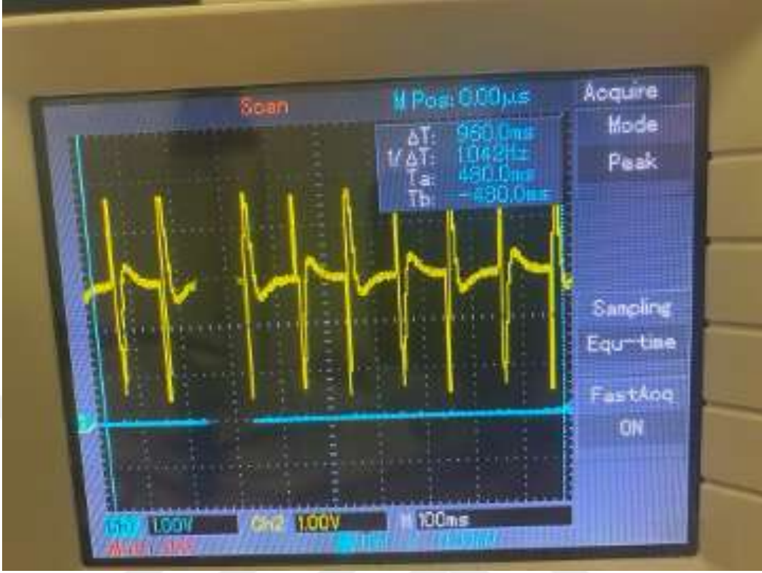
Şekil 3.7: Osiloskopta jammer sinyali
