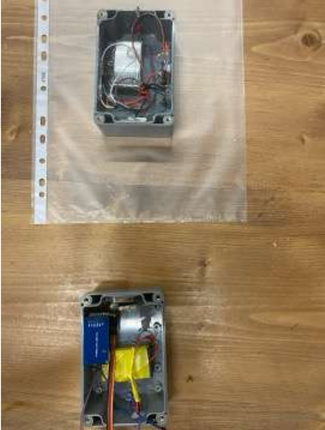
Şekil 3.8: Jammer ve veri toplama cihazı
