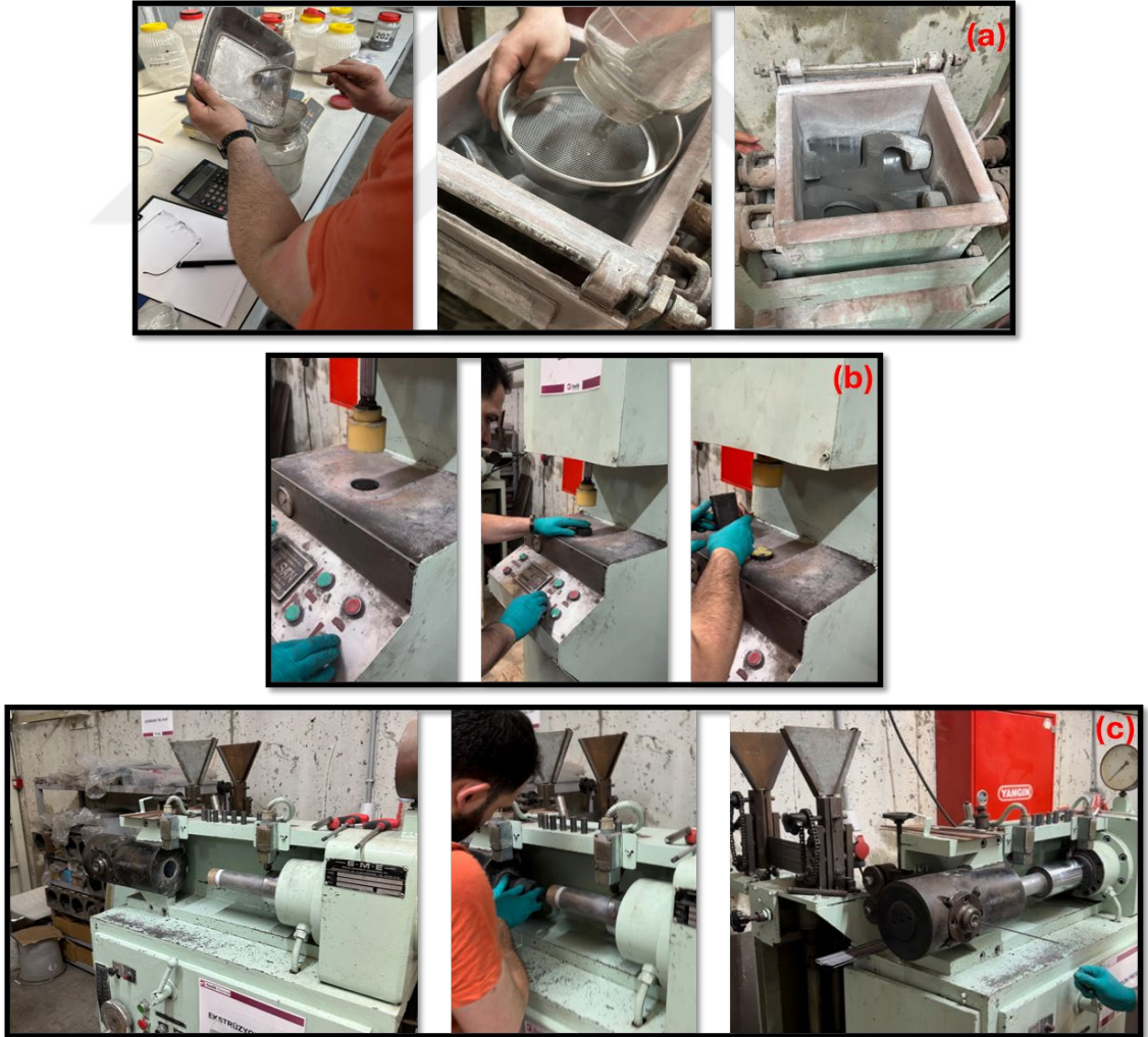
Şekil 4.1. a) Tozun tartılıp örtü hamurunun üretimi, b) Örtü hamurunun briket haline getirilme süreci, c) Elektrot telinin örtü hamuru ile kaplanması
