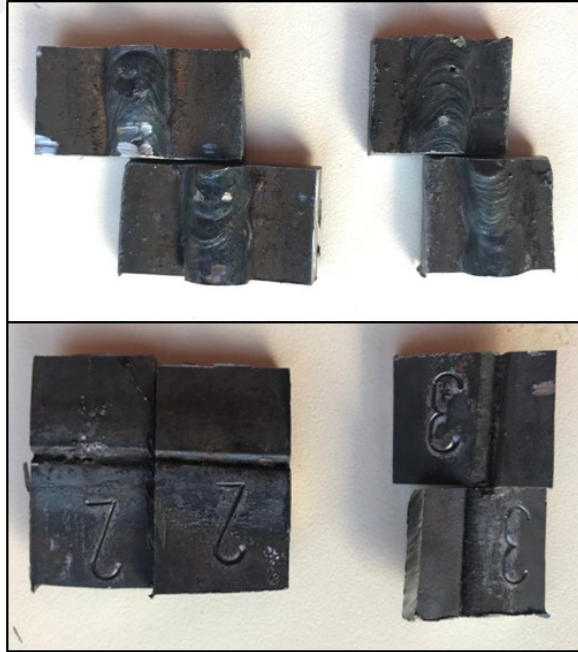
Şekil 4.4. Mikroyapı ve sertlik özelliklerini incelemek için hazırlanan numuneler
