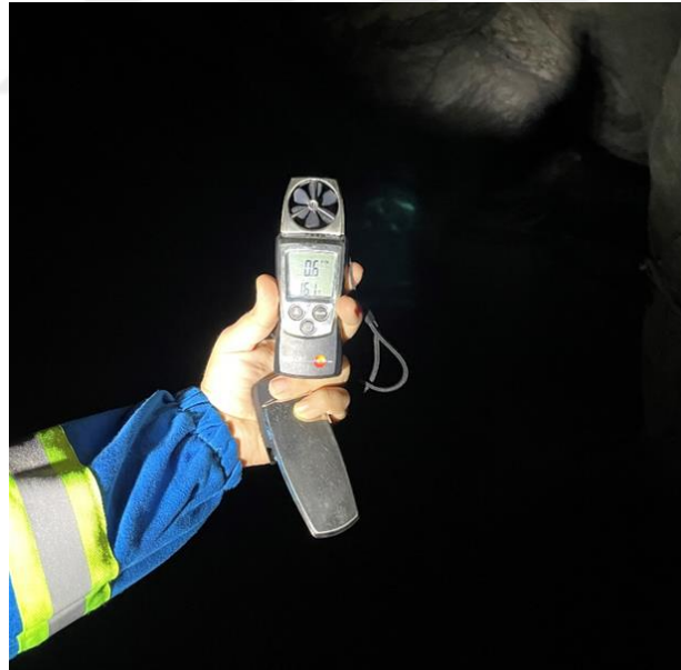
Şekil 6.2. Anemometre ile hava hızı ölçümü
