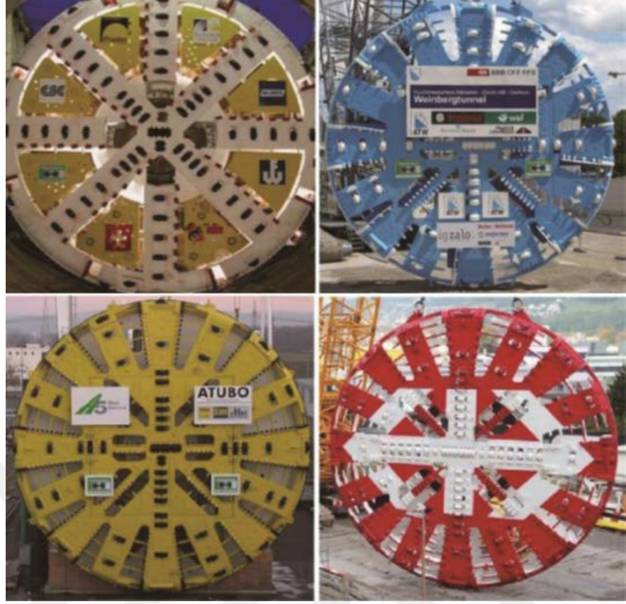
Şekil 2. 3 Döner kafaya monteli keskiler (Zumsteg ve Langmaack, 2017)
