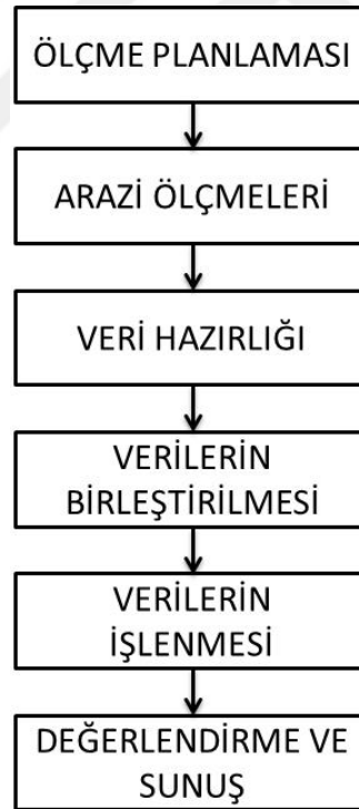
Şekil 4. 77 Yersel Lazer tarama teknikleri ile izlenmesinde kullanılan işlem adımları.
