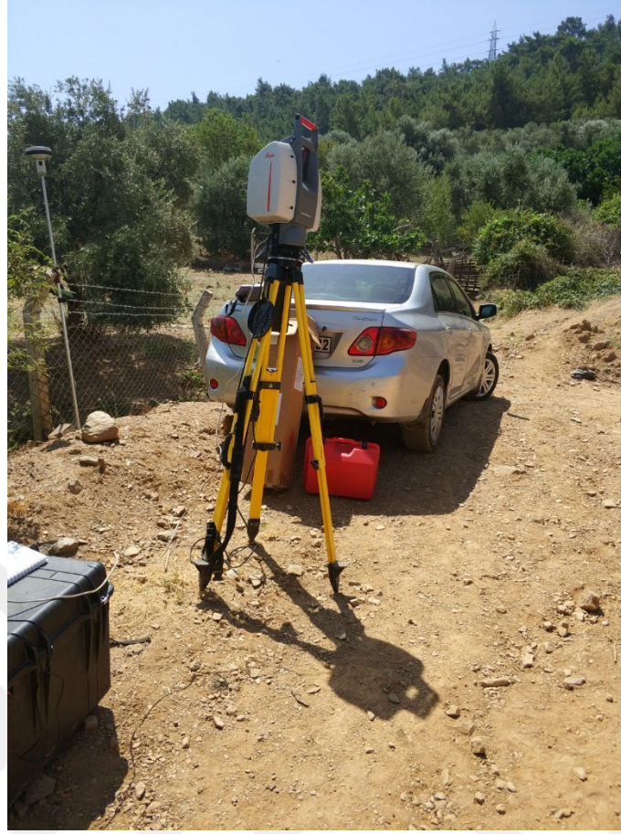
Şekil 4. 75 Yüzey deformasyonlarının belirlenmesinde kullanılan TLS tarama sistemi (Leica SS II).
