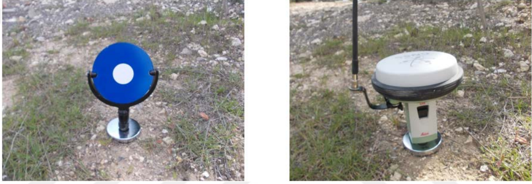
Şekil 4. 78 Hedeflerin jeodezik koordinatlarının belirlenmesinde GNSS sistemi kullanımı
