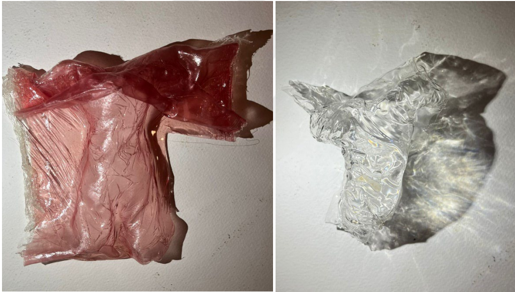
Resim 5.15 Kumaş ve Asetat Üzeri Epoksi Uygulaması İçin Malzeme Denemeleri
