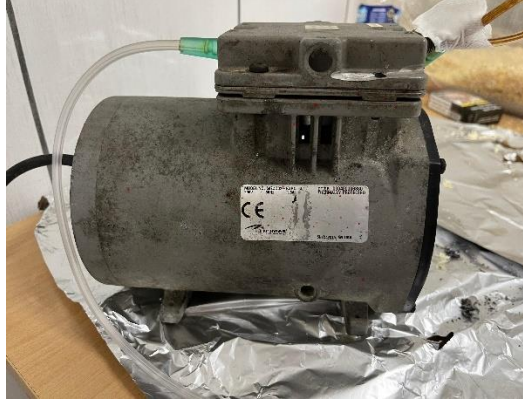
Şekil 6. Sigara ve E-Sigara Vermek İçin Kullanılan Hava Pompası
