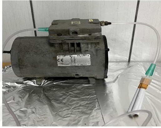
Şekil 7. Hava Pompası Yardımıyla Sigara Dumanının Kafese Verilmesi
