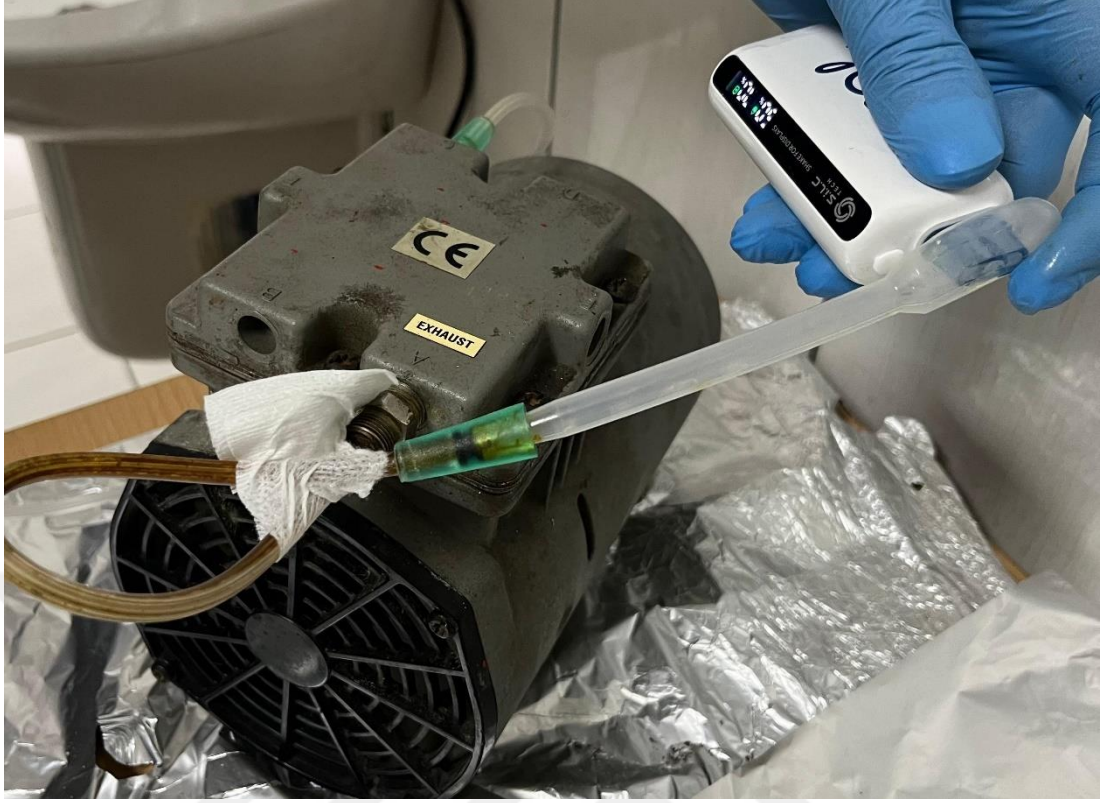
Şekil 10. Hava Pompasıyla Elektronik Sigara Verilmesi
