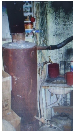
Őekil 1.17. Kee piŐirmede gerekli olan sıcak ve buharı elde etmek amacıyla kullanılan buhar kazanı (K  kkurt, 2017:64)
