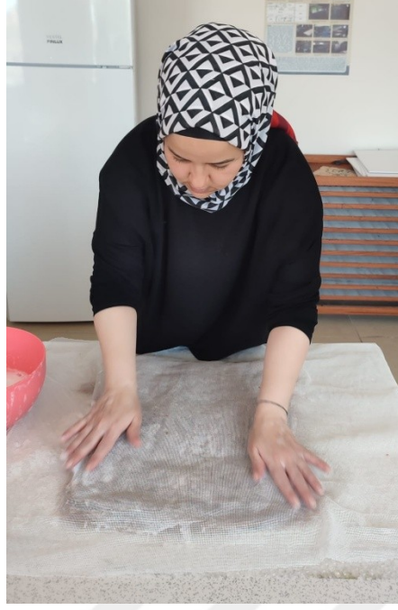
Şekil 3.58. Yün üzerine el ile baskı uygulayarak ovma aşaması (Yılmaz, 2024)
