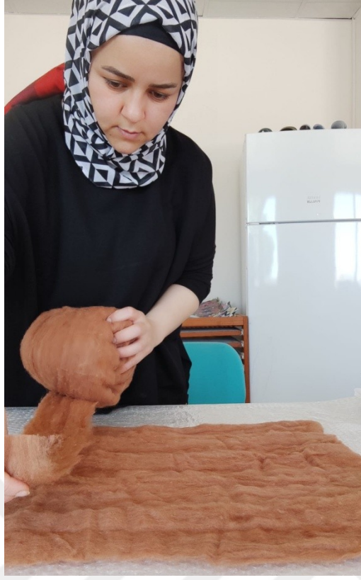
Şekil 3.39. Yünün havalı naylon üzerine boyuna serilme aşaması (Yılmaz, 2024)
