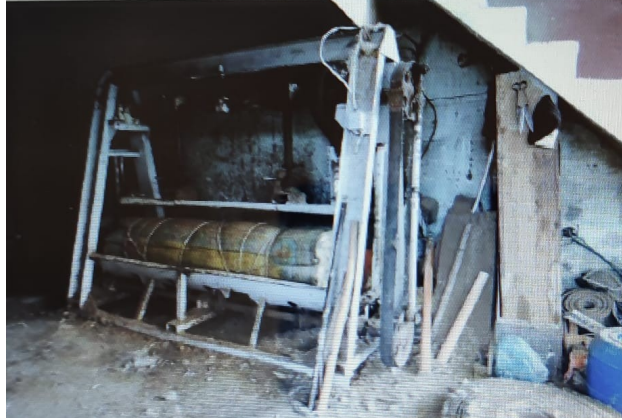
Şekil 1.26. Keçe tepme makinesinde tepme işleminin yapılışı (Sevinç ve Oyman, 2014:10)
