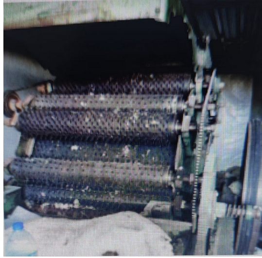
Şekil 1.8. Yünün atılmasında kullanılan hallaç makinesi (Damar, 2016:43)
