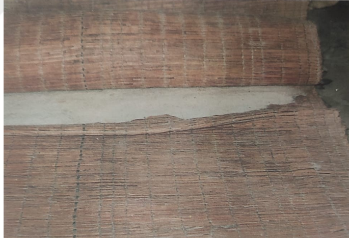
Şekil 1.9. Geleneksel (tepme) keçede kullanılan kalıp/ hasır örtü (Ergenekon,1999:57)
