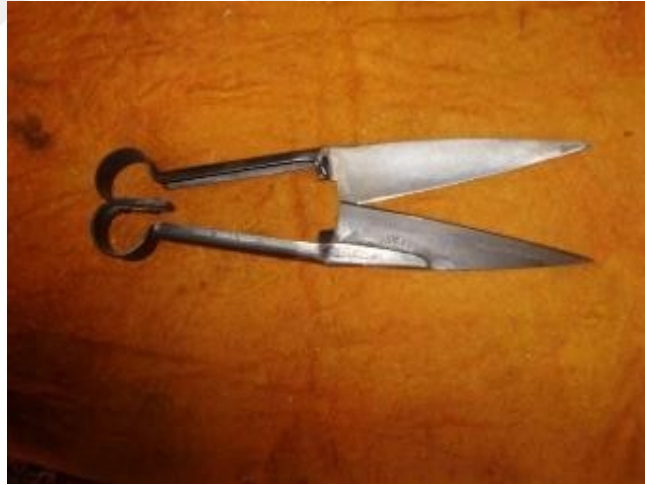
Şekil 1.13. Desenlendirme işleminde ve yünlerin kesiminde kullanılan makas (Begiç,2014:236)
