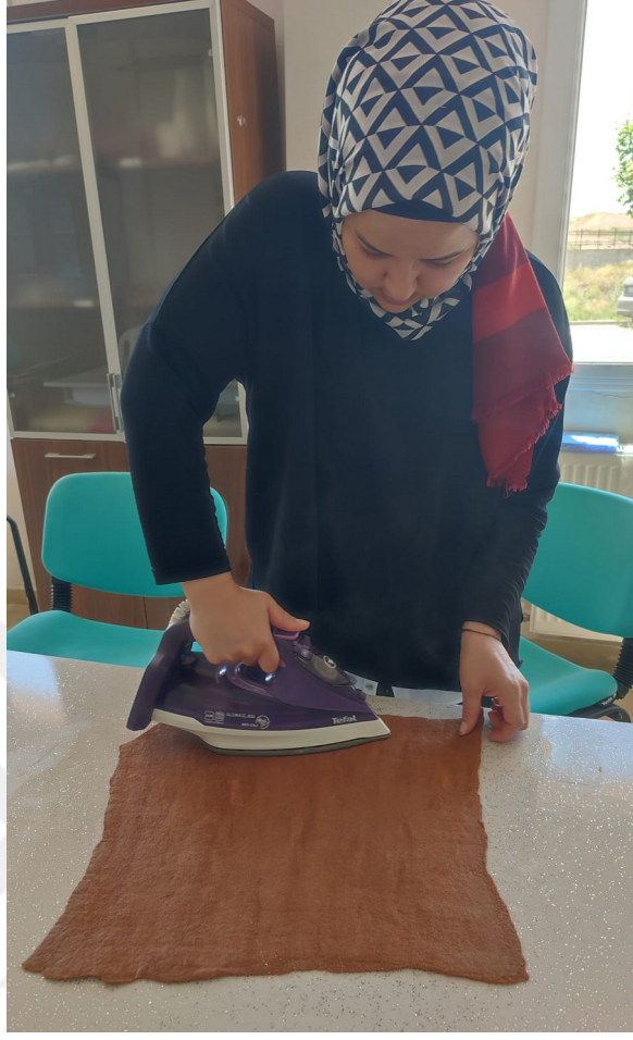
Şekil 3.51.Oluşan keçe yüzeyin ütüleme aşaması (Yılmaz,2024)
