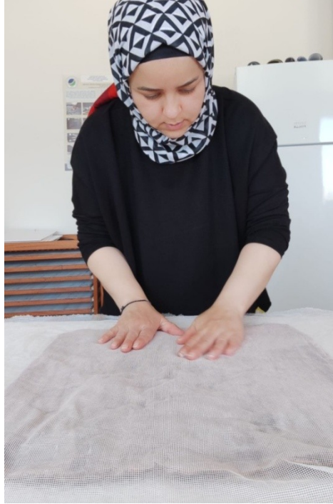
Şekil 3.43. Yünün el ile ilk keçeleşme aşaması (Yılmaz, 2024)
