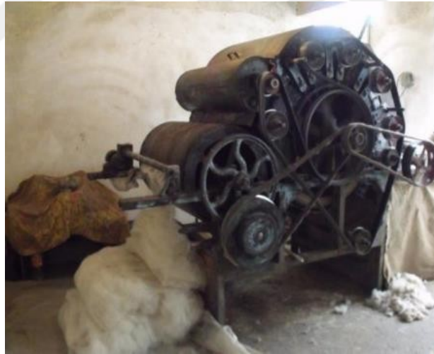
ekil 1.121. Yn Kabartma İleminde Kullanılan Halla Makinesi (Beėi, 2014:233)
