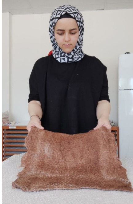
Şekil 3.61. Oluşan keçe yüzeyi havalı naylon ve tül örtü arasından çıkarma aşaması (Yılmaz,2024)
