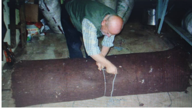
Şekil 1.10. Tepme işlemi yapılan yünün kalıpleş ile sarılması (Küçük Kurt, 2018:66)
