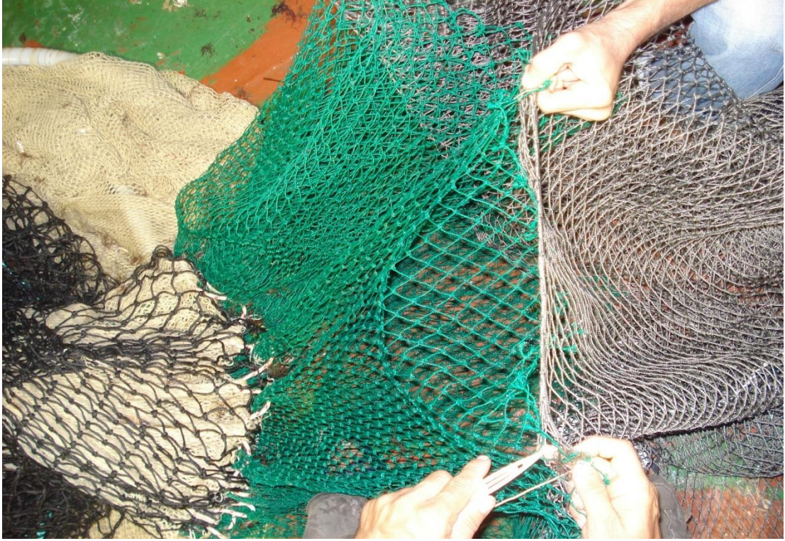
Şekil 3.6: Balıkçılık denemelerinde kullanılan dip trol ağlarının donatılması
