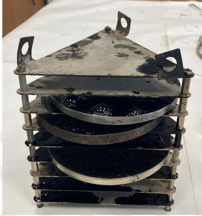
Şekil 3.13. PAV sonrası numuneler
