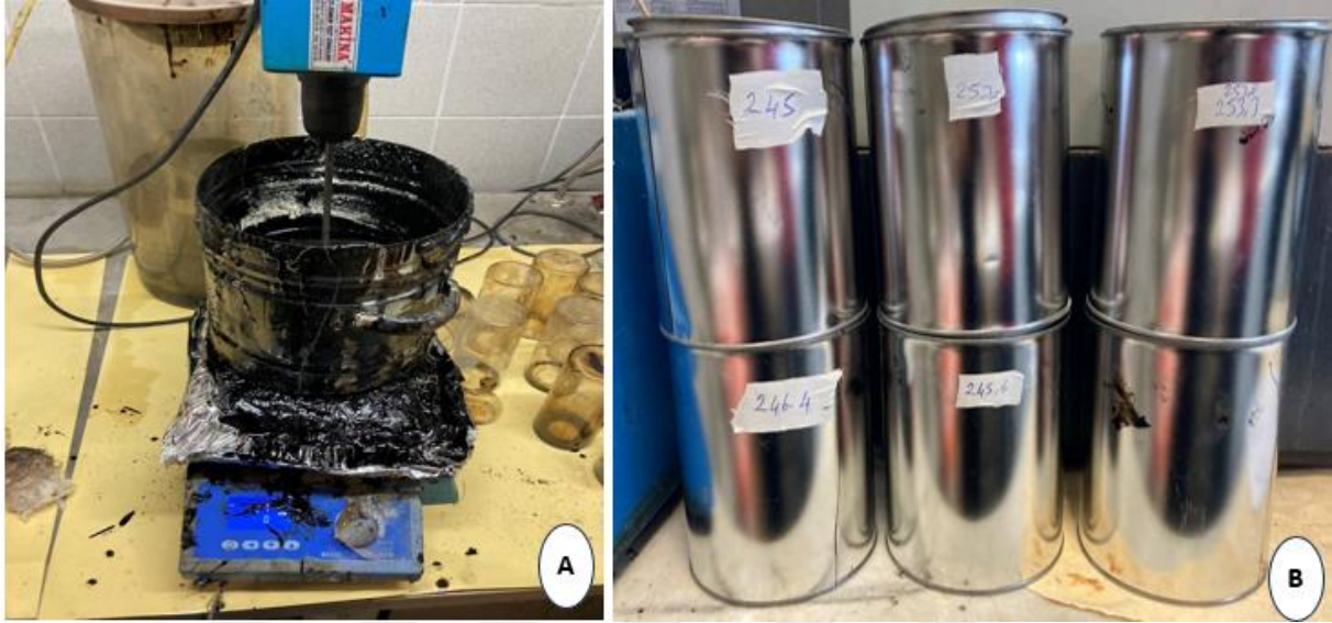
Şekil 3.2. Bitüm ile atık kuvars kumu karıştırıcısı ve numune kapları
