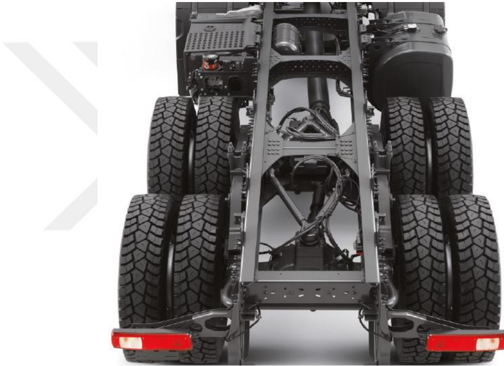
Şekil 2.25 Üçgen köşebent kullanılarak oluşturulan bir şasi tasarımı (Renault, 2024)
