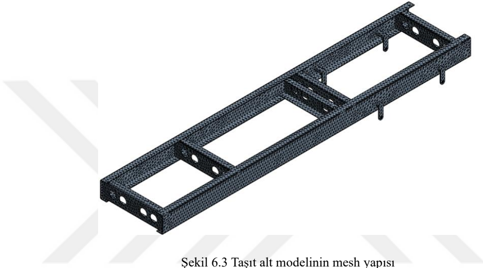
Şekil 6.3 Taşıt alt modelinin mesh yapısı
