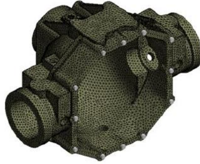
Şekil 4.7 İdeal mesh tipi ve boyutuna sahip bir analiz modeli (Topaç vd., 2016)
