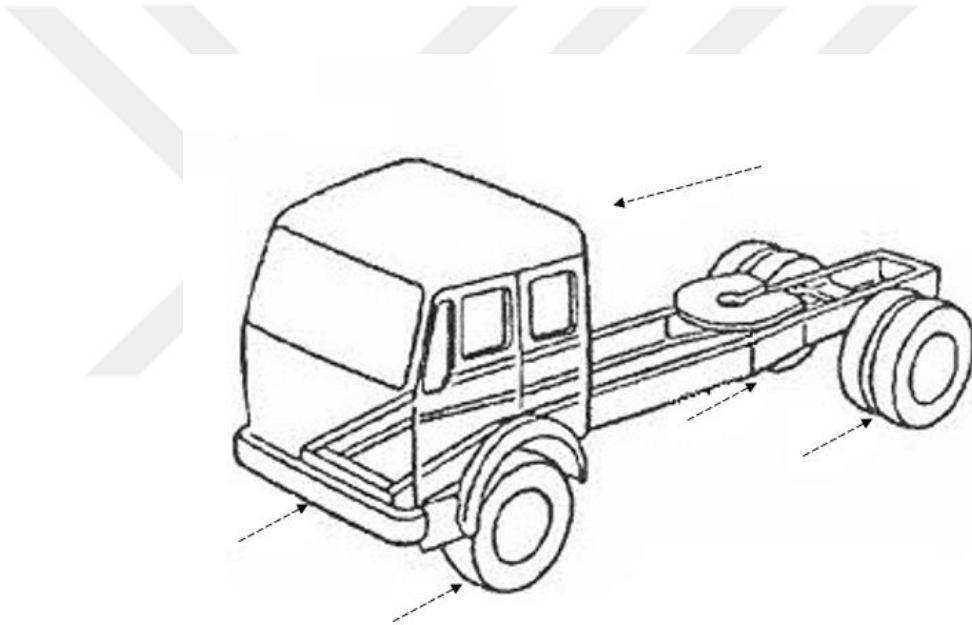
Şekil 3.5 Kamyon şasisine etkiyen frenleme ve ivmelenme kuvvetleri (Rubi ve Strifler, 1993)
