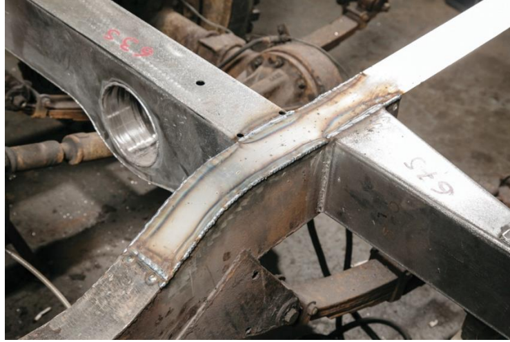
Şekil 2.27 Kaynak işlemi uygulanarak oluşturulmuş taşıt şasi yapısı (Land Rover, 2021)
