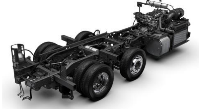
Şekil 2.26 Kapalı kesitli profiller kullanılarak oluşturulmuş bir şasi platformu (Scania, 2015)
