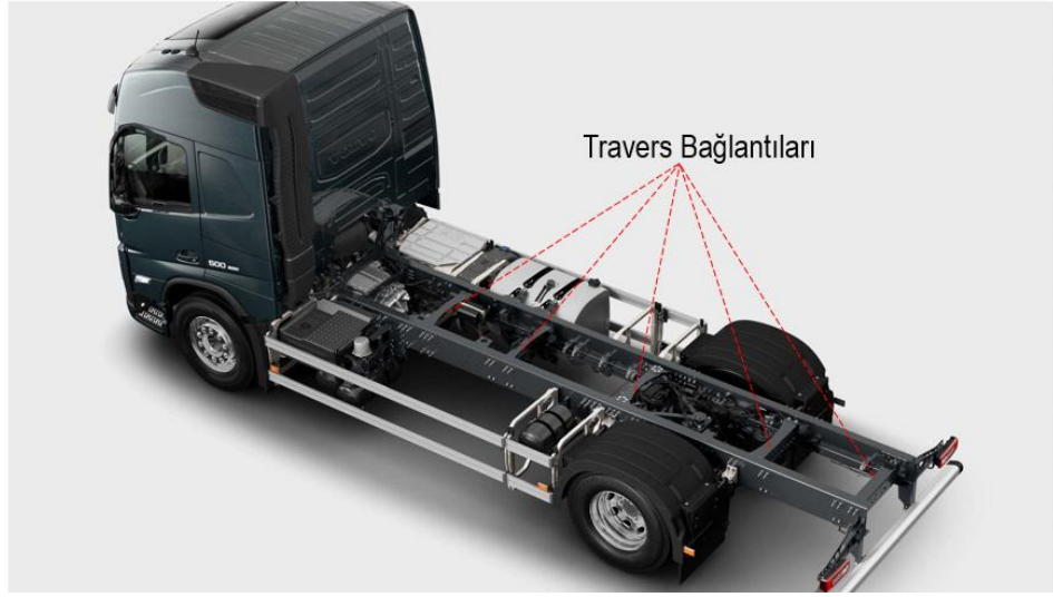
Şekil 2.10 Çok amaçlı bir taşıta ait travers tasarım detayları (Volvo, 2021)
