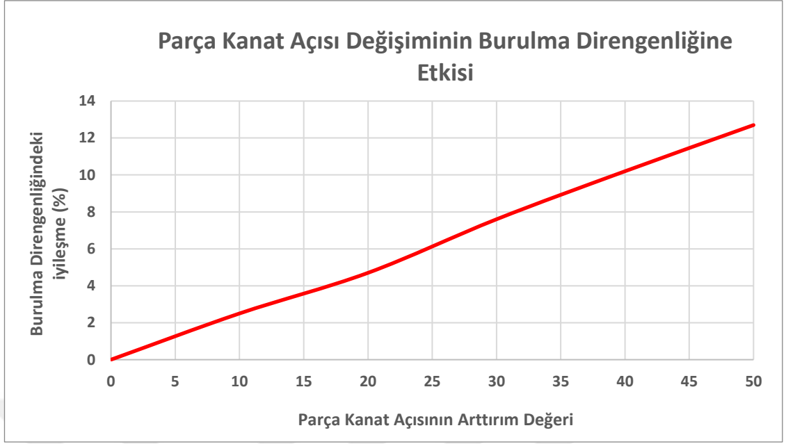
Şekil 7.7 Parça kanat açısı değişiminin burulma direngenliğine etkisi
