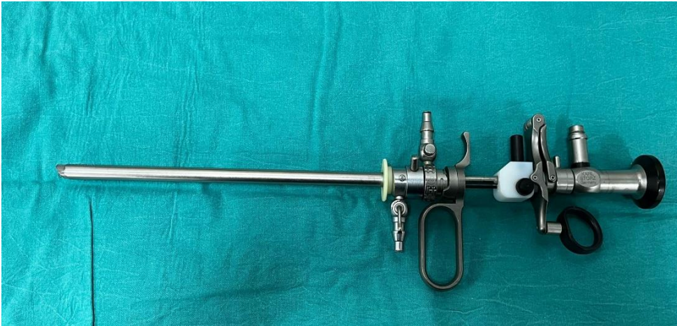
Şekil 7: Çalışmada kullanılan 27-Fr (9 mm) kılıflı ve 4 mm çaplı histeroskop (Gynecare Versapoint Sistemi; Ethicon, Somerville, NJ)
