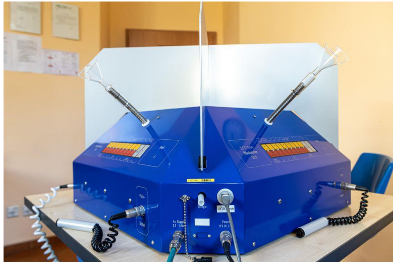
Şekil 3.1. Koku analizi TO8 olfaktometre cihazı (Jońca, 2021)
